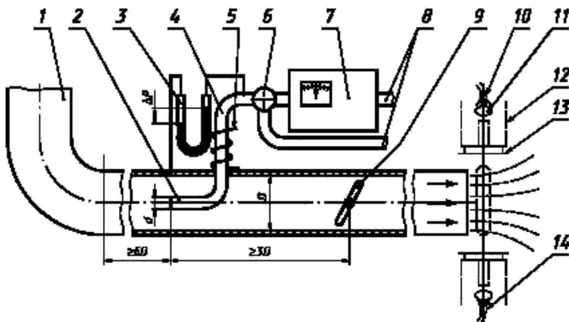
1 — выпускная труба; 2 — газоотборный зонд; 3 — дифференциальный манометр; 4 — газоподводящая труба; 5 — теплообменник; 6 — байпасный клапан; 7 — дымомер частично-поточный; 8 — газоотводящие трубы; 9 — регулируемая заслонка; 10 — источник света; 11 — собирательная линза; 12 — дымомер полнопоточный (на срезе выпускной трубы); 13 — разделительная перегородка; 14 — приемник света
