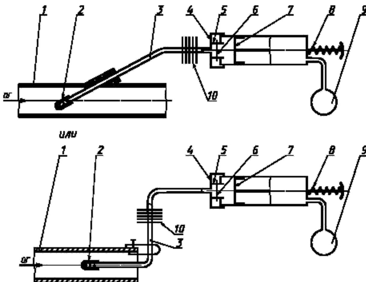
1 — прямолинейный участок трубы двигателя; 2 — газоотборный зонд; 3 — линия отбора; 4 — дымомер; 5 — зажимное устройство; 6 — фильтр; 7 — поршни; 8 — пружина; 9 — пневматическое устройство; 10 — охладитель
