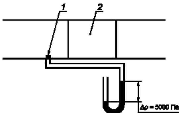
1 — закрытое отверстие отбора давления; 2 — секция испытательного устройства
