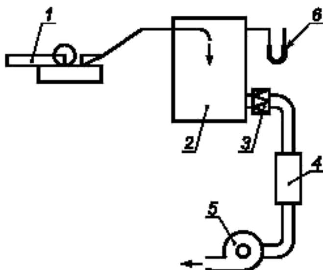
1 — генератор пыли; 2 — емкость объемом не менее 0,25 м<sup>3</sup>;
