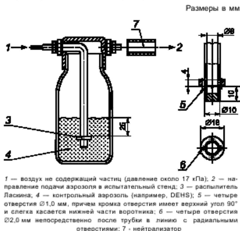
Рисунок 4 — Система генерирования частиц DEHS
