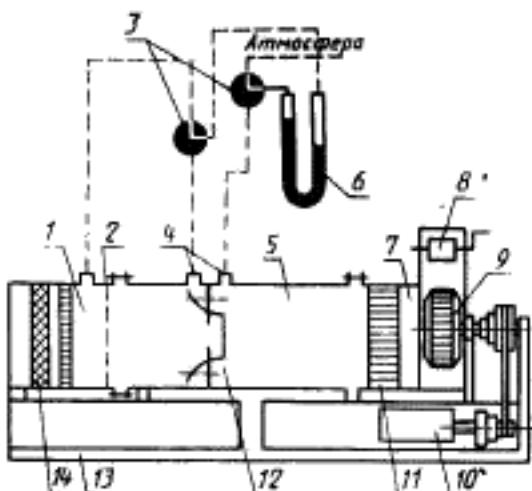
1 – приемная камера; 2 – рассеиватель; 3 – двухходовые краны; 4 – штуцера для присоединения микроманометра; 5 – измерительная камера; 6 – микроманометр; 7 – разгрузочная камера; 8 – заслонка; 9 – вентилятор; 10 – двигатель вентилятора; 11 – выпрямляющая решетка; 12 – измерительное сопло; 13 – основание установки; 14 – смеситель воздуха
