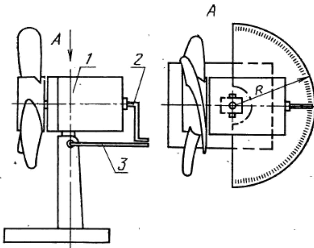
1—корпус вентилятора; 2—стрелка-указатель; 3—измерительная
