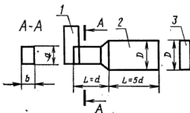
1—вентилятор; 2—переходной цилиндр; 3—анемометр
