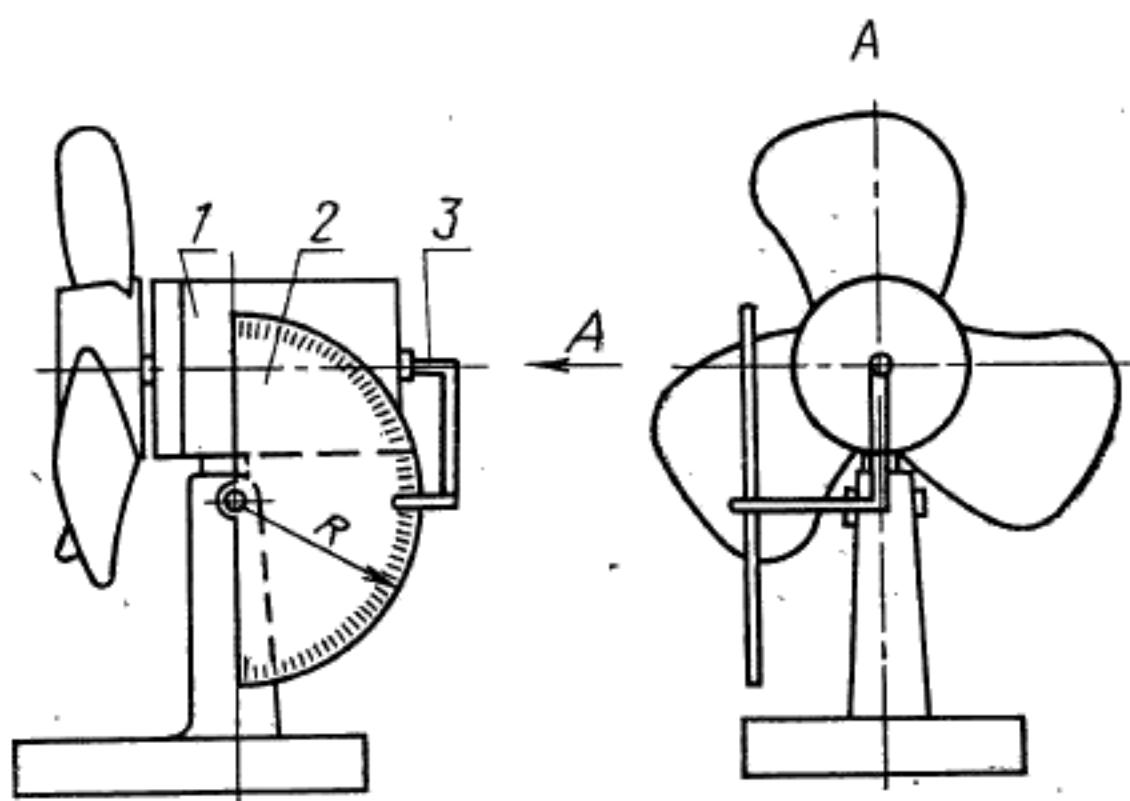
1—корпус вентилятора; 2—измерительная шкала; 3—стрелка-указатель
