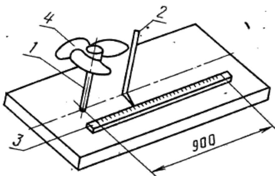
1—вал; 2—указатель; 3—шкала; 4—крыльчатка
