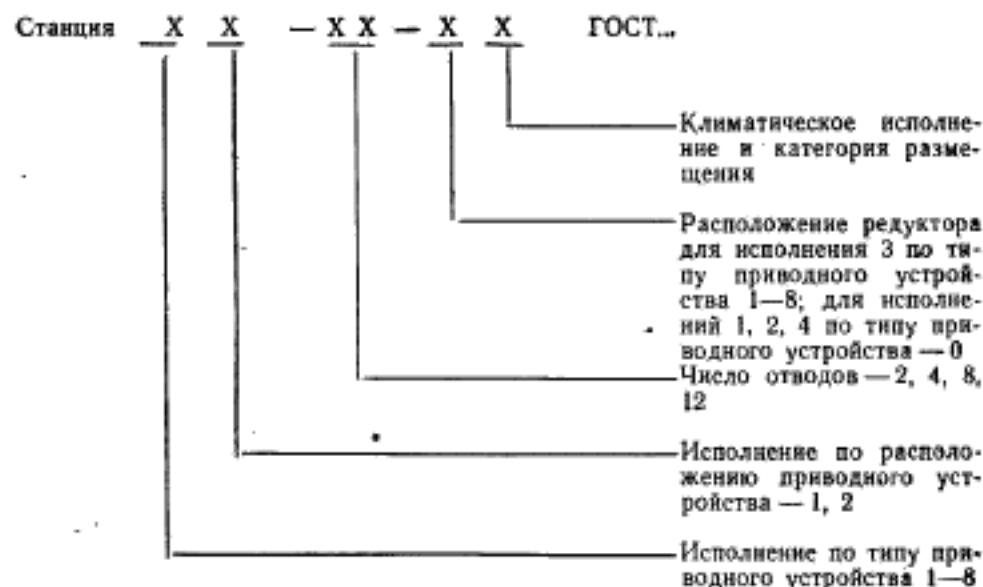
Пример условного обозначения станции исполнения 1, с правым расположением приводного устройства, с 4 отводами, со свободным концом вала, расположенным справа, предназначенной для работы в умеренном климате для категории размещения 4:
