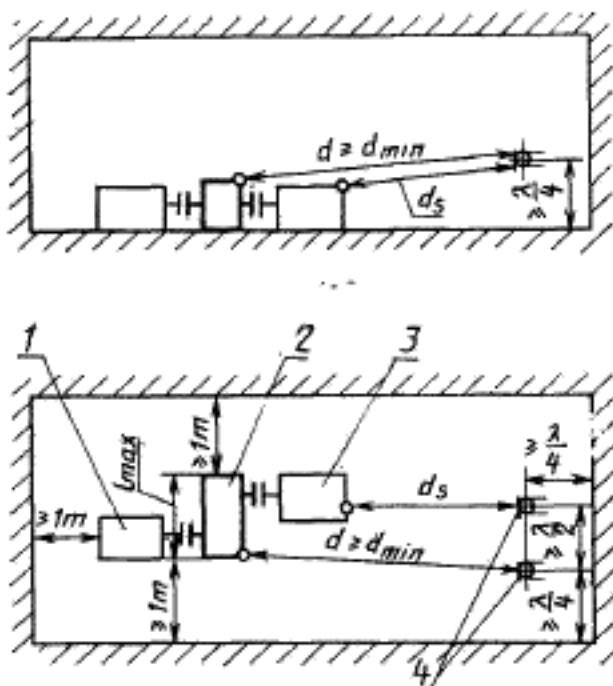
1 — приводной узел; 2 — редуктор; 3 — нагруженный узел; 4 — микрофон
