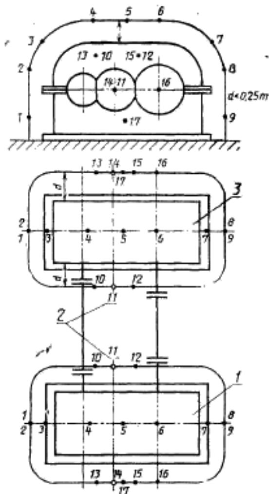
1 — редуктор № 1; 2 — точки измерения (11) допускаются только при обеспечении безопасной работы; 3 — редуктор № 2
