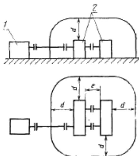
1 — приводной механизм; 2 — нагруженные редукторы
