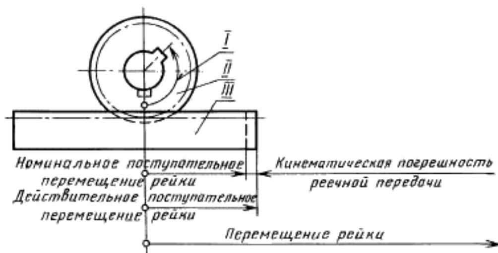
I — действительный угол поворота зубчатого колеса; II — зубчатое колесо; III — рейка
