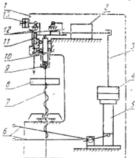
1 — корпус; 2 — блок управления сигнализацией; 3 — подвеска; 4 — сменные грузы; 5 — демпфер; 6 — рукоятки управления; 7 — винт; 8 — стол; 9 — индентор; 10 — штан; 11 — индикатор; 12 — вытяжная система, 13 — противовес установки предварительной нагрузки
