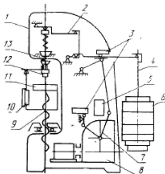
1 — корыто; 2 — рычажная система; 3 — микроповеркающий элемент; 4 — подвеска; 5 — блок управления; 6 — сменные грузы; 7 — рычаги привода; 8 — редуктор; 9 — винт; 10 — индикатор; 11 — стол; 12 — индентор; 13 — пружина предварительной нагрузки
