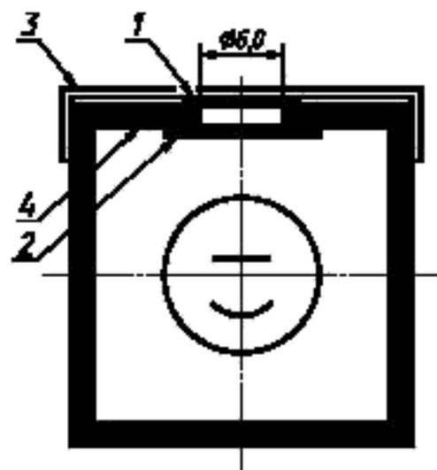
1 – ЛЮМИНЕСЦЕНТНЫЙ ЭКРАН; 2 – свинцовое стекло; 3 – кожух; 4 – выходная плоскость ЛЮМИНЕСЦЕНТНОГО ЭКРАНА
