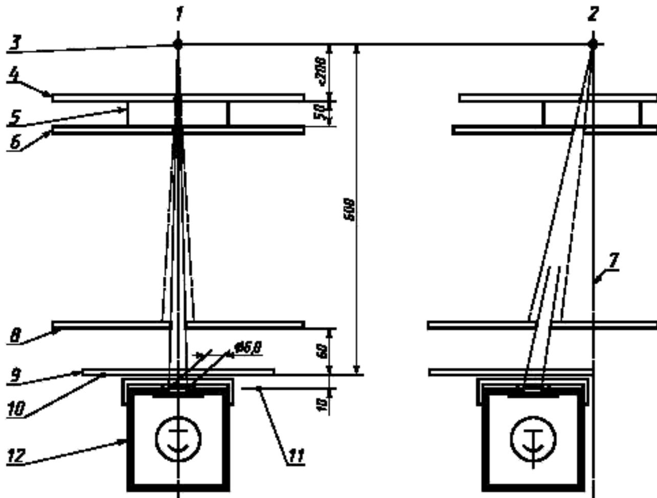
1 — вид спереди; 2 — вид сбоку; 3 — ФОКУСНОЕ ПЯТНО; 4 — ДИАФРАГМА; 5 — ФАНТОМ; 6 — ДИАФРАГМА; 7 — положение боковой стороны, обращенной к пациенту; 8 — ДИАФРАГМА; 9 — ОТСЕИВАЮЩИЙ РАСТР; 10 — поддерживающая плоскость; 11 — выходная плоскость ЛЮМИНЕСЦЕНТНОГО ЭКРАНА; 12 — ДЕТЕКТОР ИЗЛУЧЕНИЯ
