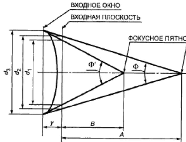
$d_1$  — РАЗМЕР РАБОЧЕГО ВХОДНОГО ПОЛЯ, соответствующий углу  $\Phi'/2$  (т. е. РИВ =  $B$ ), см;  $d_2$  — РАЗМЕР РАБОЧЕГО ВХОДНОГО ПОЛЯ, соответствующий углу  $\Phi/2$  (т. е. РИВ =  $A$ ), см;  $d_3$  — НОМИНАЛЬНЫЙ РАЗМЕР ВХОДНОГО ПОЛЯ УРИ во входном окне, см
