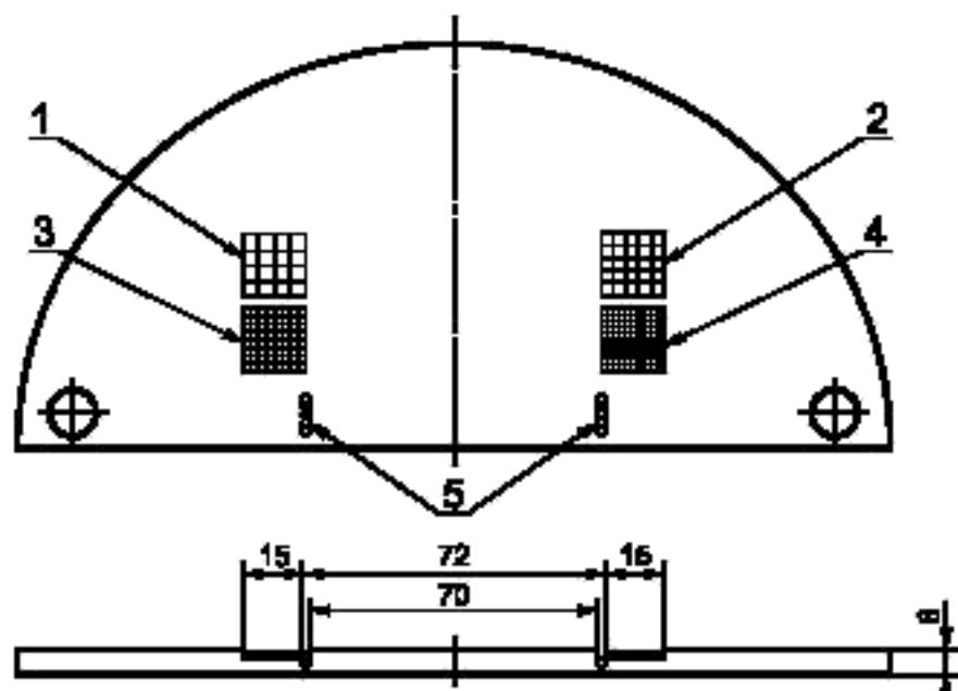
1—4 — проволочная сетка из нержавеющей стали; 1 — шаг сетки 100 микрон, диаметр проволоки 80 микрон; 2 — шаг сетки 80 микрон, диаметр проволоки 50 микрон; 3 — шаг сетки 63 микрон, диаметр проволоки 40 микрон; 4 — шаг сетки 40 микрон, диаметр проволоки 32 микрон; 5 — цепочка из шариков диаметром 2 мм для проверки положения пучка излучения
