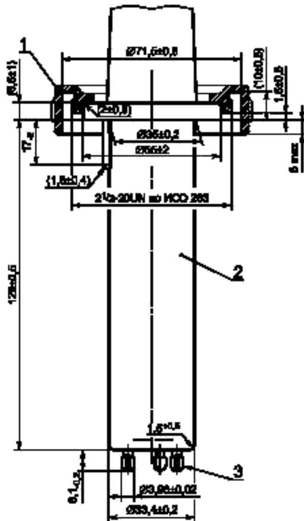
1 — кольцевая гайка; 2 — наконечник, 3 — контактные штыри
