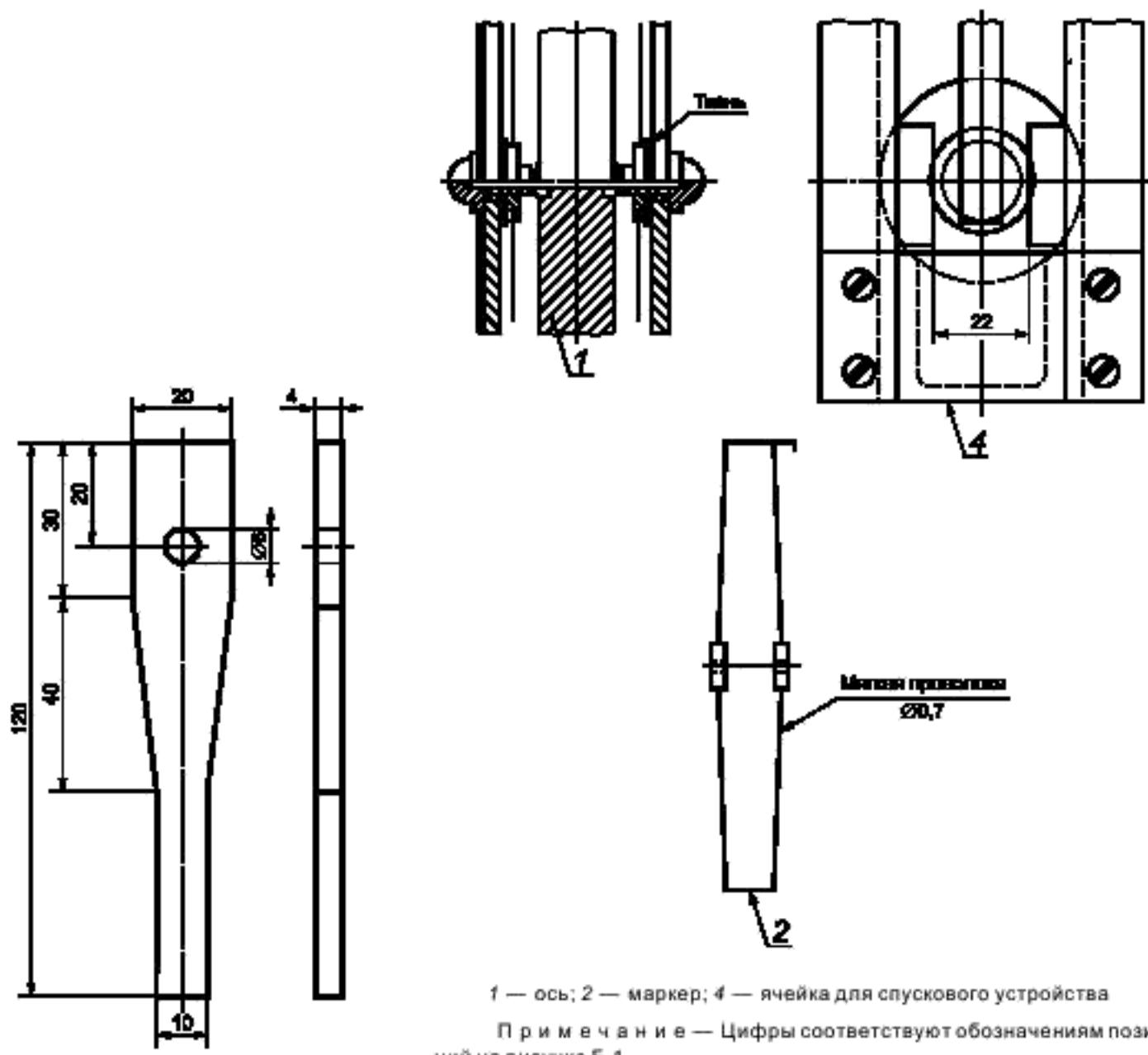
Рисунок Б.3 — Стальная пружина маятника
