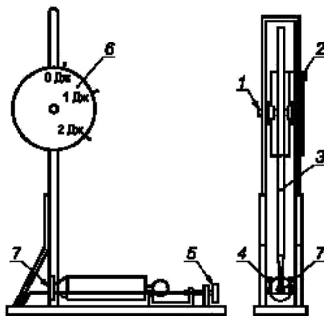
1 — ось; 2 — маркер; 3 — маятник; 4 — ячейка для спускового устройства; 5 — спусковое устройство; 6 — шкала;
