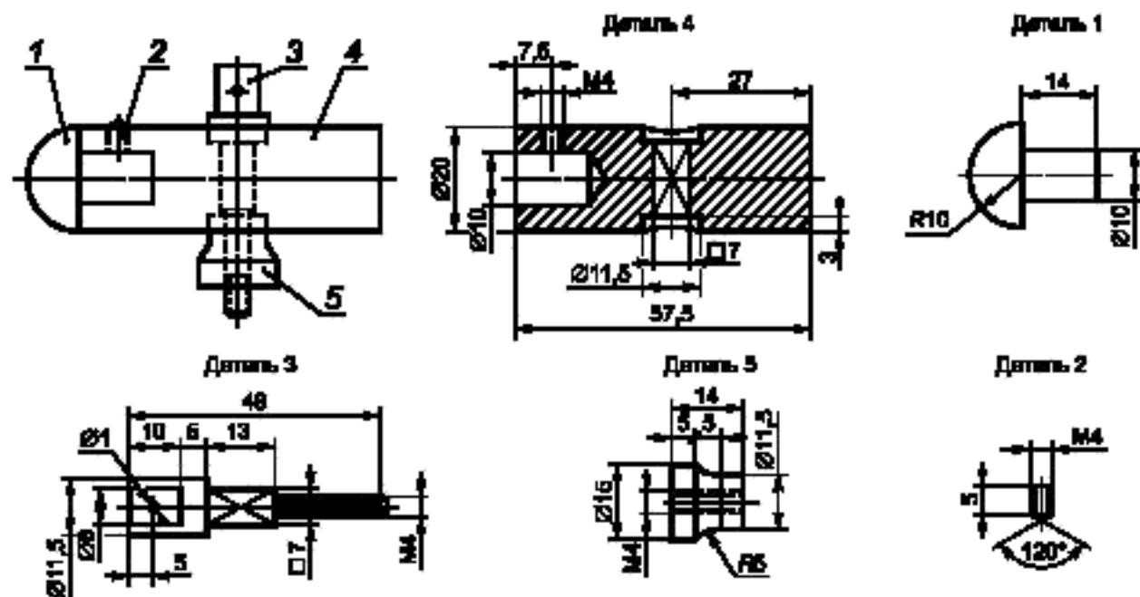
1 — корпус; 2 — штырь маятника; 3 — высота перемещения; 4 — монтажное приспособление; 5 — образец
