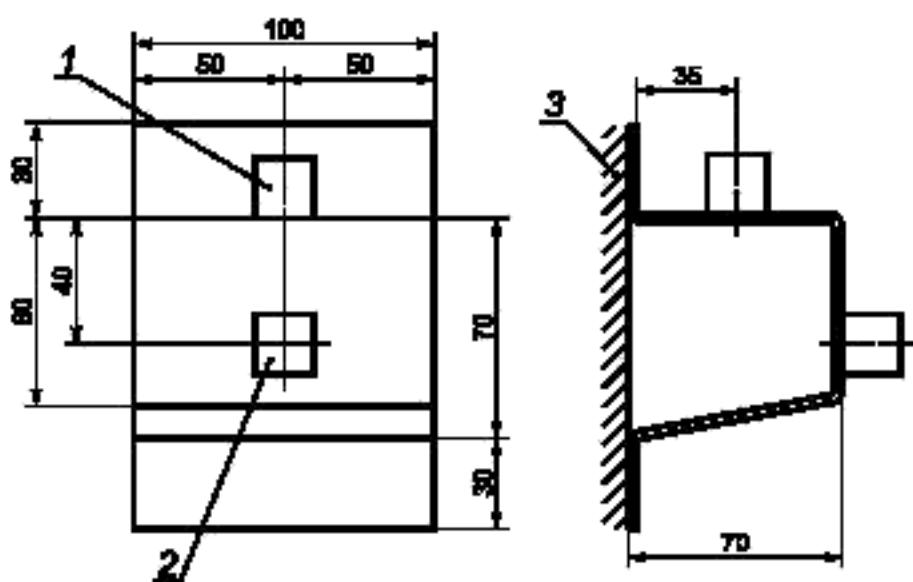
1 — образец для поверхности или полувстраеннного крепления; 2 — образец полувстраеннного крепления;
