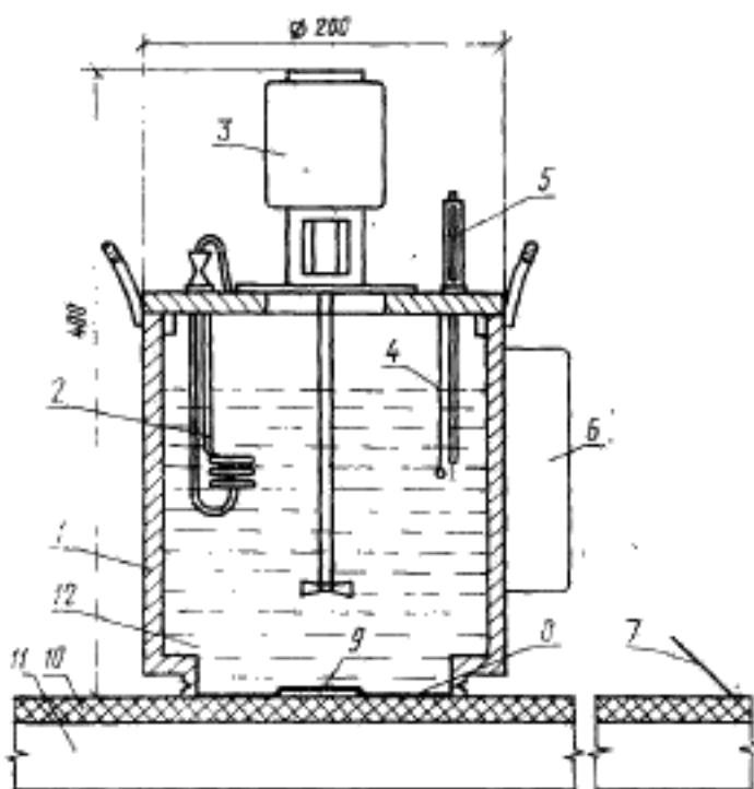
1 — сосуд цилиндрической формы; 2 — электронагреватель трубчатый; 3 — электромешалка; 4, 7 — термопары; 5 — электроконтактный термометр; 6 — блок управления; 8 — алю из полиэтиленовой или поливинилхлоридной пленки; 9 — термометр (измеритель теплового потока); 10 — испытуемый образец; 11 — бетонная плита; 12 — дистиллированная вода
