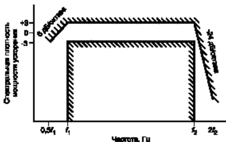
Рисунок 2 — Границы допуска для спектральной плотности мощности ускорения
