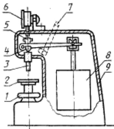
1—гайка-маховик; 2—подъемный столик; 3—индентор; 4—призма рычага основной нагрузки; 5—штангидр с грузом предварительной нагрузки; 6—отсчетное устройство; 7—руковятка приложения и снятия основной нагрузки; 8—грузы для основной нагрузки; 9—корпус
