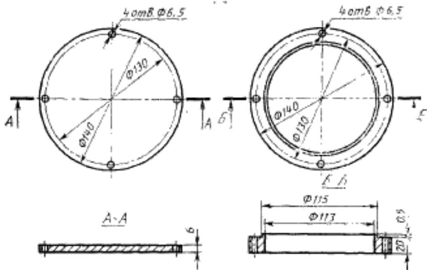
Примечание. Для скрепления деталей формы применяют болты М6×25.
