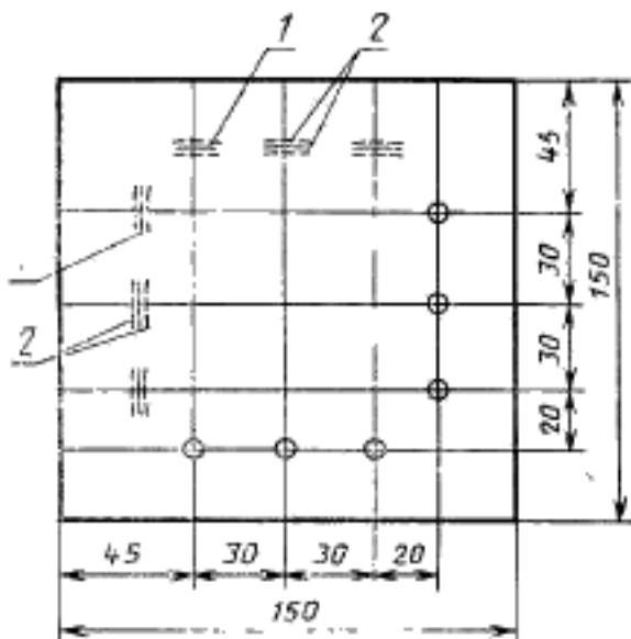
1—риски до испытания; 2—риски после испытания
