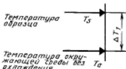
**Стадия 1.** Образец находится под нагрузкой. Испытание в условиях камеры без принудительной циркуляции воздуха и при отсутствии охлаждения образца.
