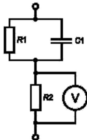
Компоненты:  $R1 = 1500 \text{ Ом}$ ;  $R2 = 500 \text{ Ом}$ ;  $C1 = 0,22 \mu\text{Ф}$ ;  $V$  — вольтметр
