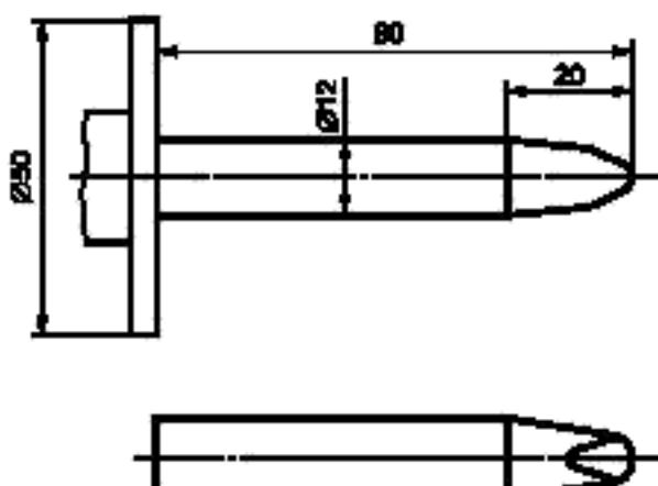
Рисунок В.1 — Жесткий испытательный палец
