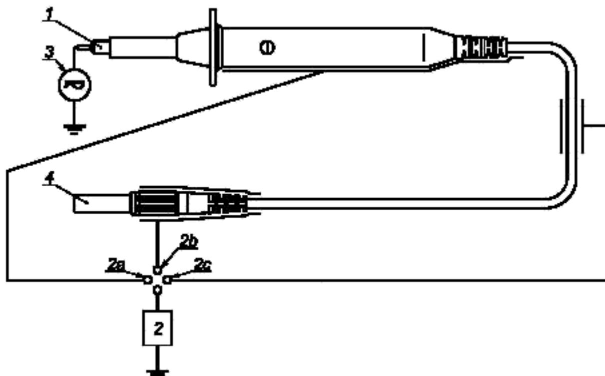
1 — НАКОНЕЧНИК щупа, 2 — схема измерения тока (см. приложение А); 2a — контакт с металлической фольгой, покрывающей части, к которым прикасается рука; 2b — контакт с металлической фольгой, покрывающей соединители; 2c — контакт с металлической фольгой, покрывающей кабель (см. 6.4.3); 3 — максимальное нормированное напряжение; 4 — оборудование отключено
