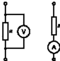
Компоненты:  $A$  — амперметр;  $R = 2\,000 \text{ Ом}$ ;  $V$  — вольтметр
