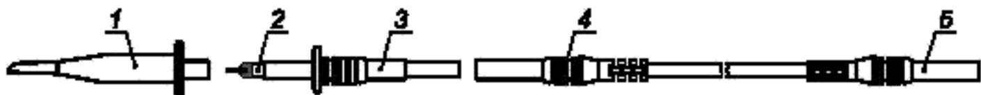
1 — принадлежность НАКОНЕЧНИКА ЩУПА; 2 — НАКОНЕЧНИК ЩУПА; 3 — КОЖУХ щупа; 4 — СОЕДИНИТЕЛЬ; 5 — разъем для подключения к оборудованию
