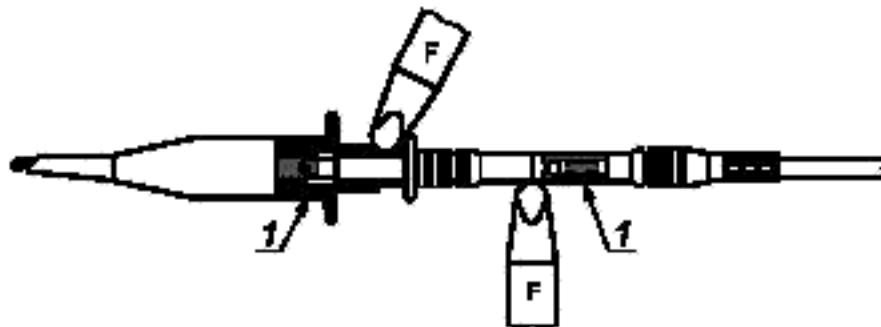
1 — соединитель; F — жесткий испытательный палец
