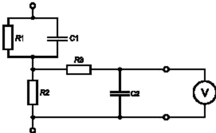
Компоненты:  $C1 = 0,22 \text{ мкФ}$ ;  $C2 = 0,022 \text{ мкФ}$ ;  $R1 = 1500 \text{ Ом}$ ;  $R2 = 500 \text{ Ом}$ ;  $R3 = 10 \text{ кОм}$ ;  $V$  — вольтметр
