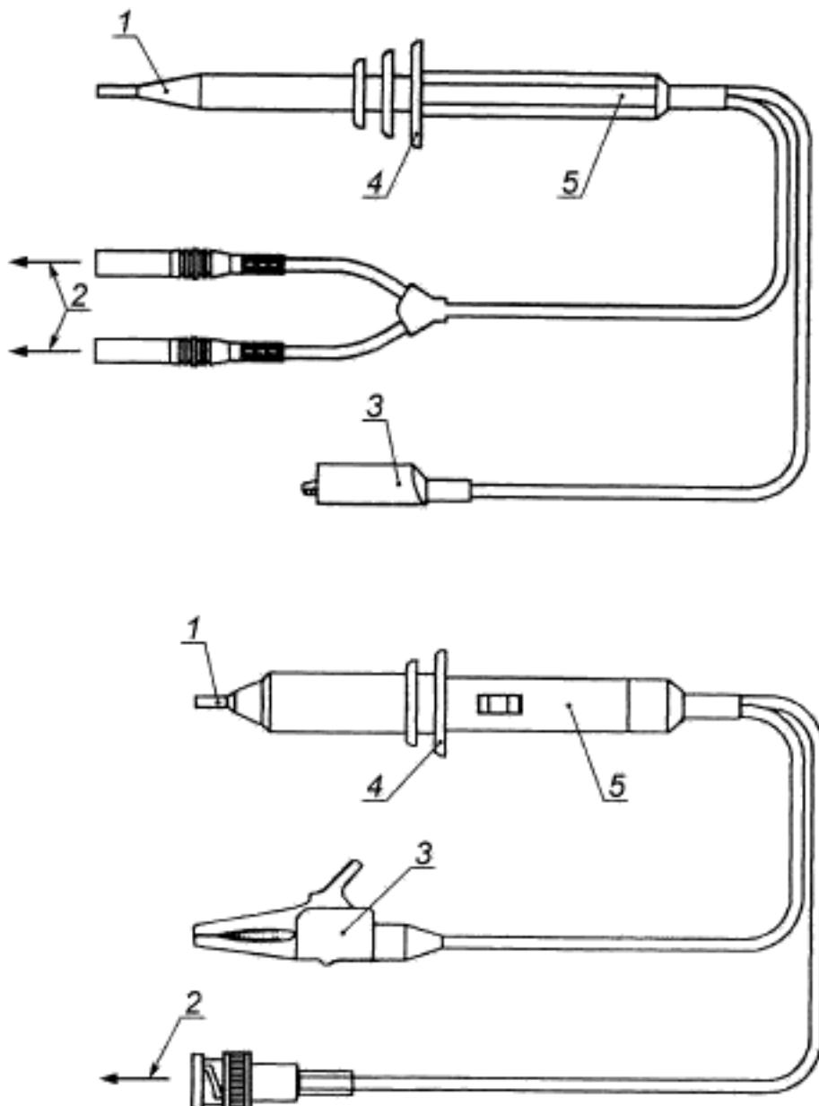
1 — НАКОНЕЧНИК; 2 — ххонтрольно-измерительному или испытательному оборудованию; 3 — части соединителей;
