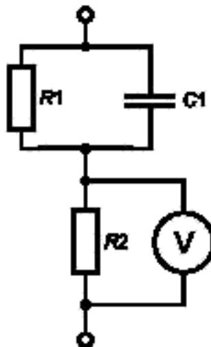
Компоненты:  $R1=375 \text{ Ом}$ ;  $R2=500 \text{ Ом}$ ;  $C1=0,22 \mu\text{Ф}$ ;  $V$  — вольтметр
