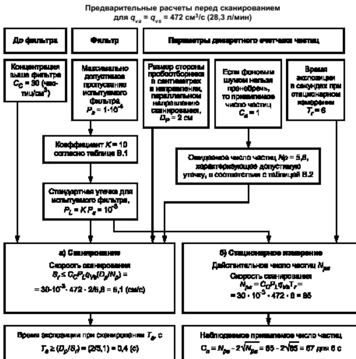
Рисунок В.3 — Схема проведения предварительных расчетов
