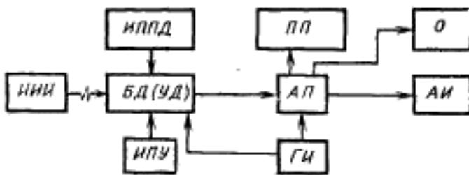
**ИИИ** — источник ионизирующих излучений; **БД(УД)** — испытуемый блок или устройство детектирования; **ИППД** — источник питания детектора; **ИПУ** — источник питания предуслышника; **АП** — аналоговый процессор; **ГИ** — генератор импульсов; **ПП** — пересчетный прибор; **О** — осциллограф; **АИ** — многоканальный амплитудный анализатор импульсов
