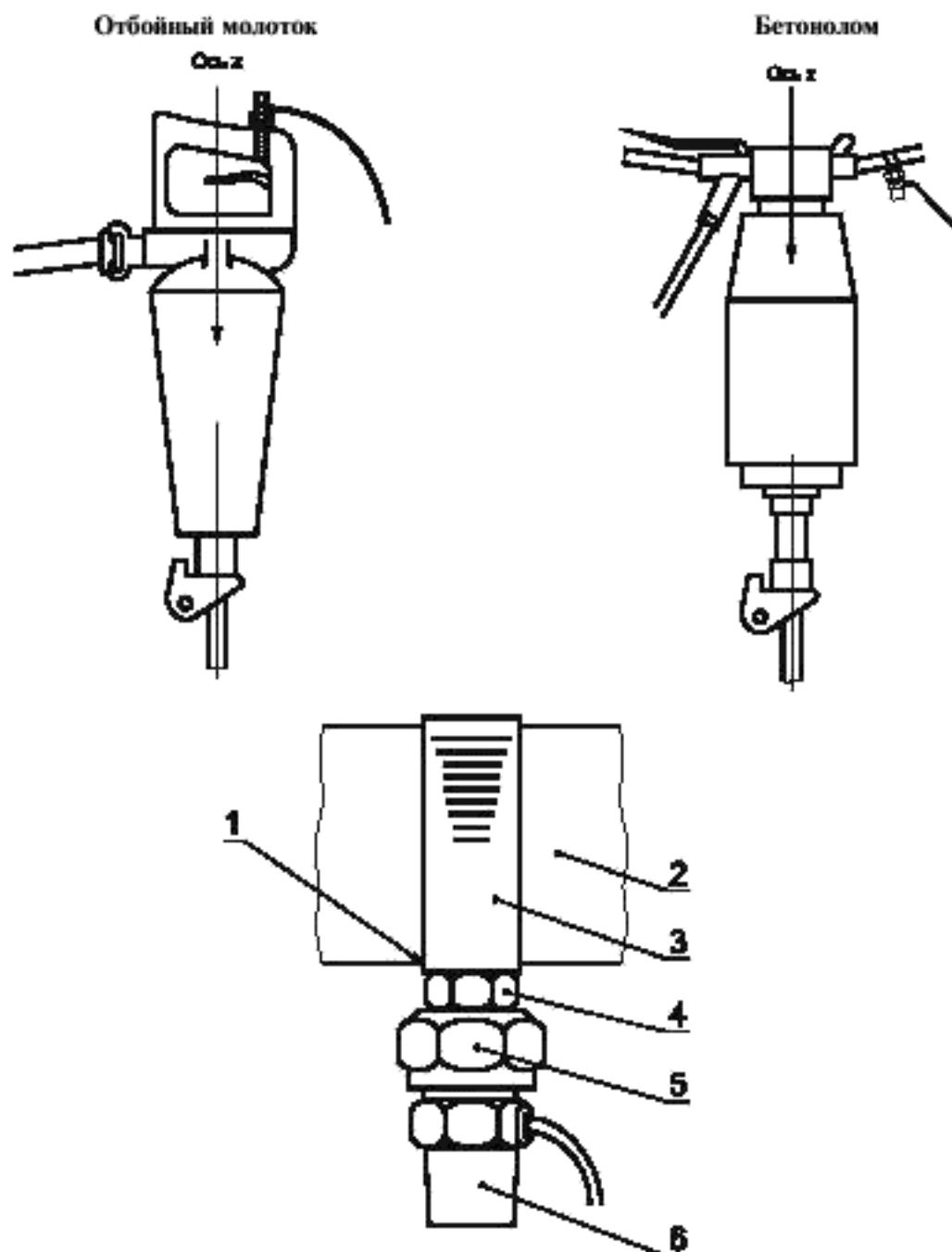
1 — площадка с отфрезерованной поверхностью; 2 — рукоятка; 3 — обжимной хомут;
