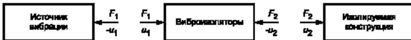
Рисунок 1 — Блок-схема системы «источник вибрации — виброизоляторы — изолируемая конструкция»
