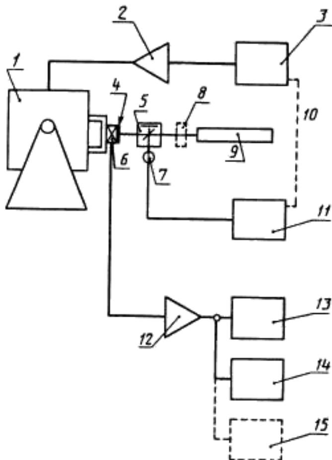
1 — вибратор; 2 — усилитель мощности; 3 — генератор частоты и индикатор; 4 — плоское зеркало; 5 — интерферометр; 6 — акселерометр; 7 — фотодетектор; 8 — оптический фильтр; 9 — лазер; 10 — только для счета отношения; 11 — счетчик (или счетчик отношения); 12 — усилитель; 13 — вольтметр; 14 — измеритель нелинейных искажений; 15 — осциллограф
