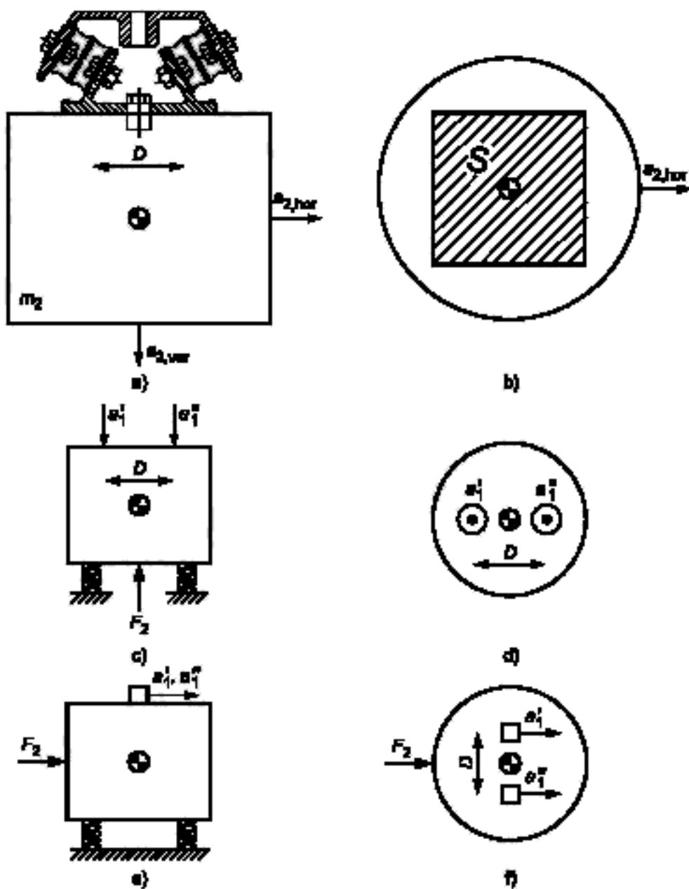
Рисунок 10 — Экспериментальное определение эффективной массы
