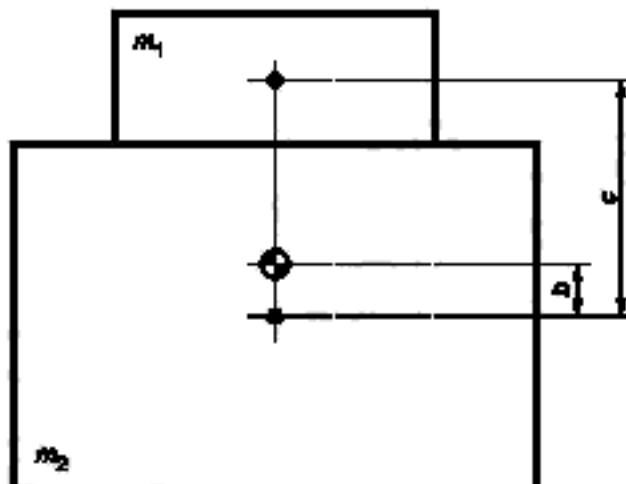
$c$  — расстояние между центрами масс нагружающей массы и фланца;  $b$  — расстояние между центрами масс нагружающей массы и составного тела;
