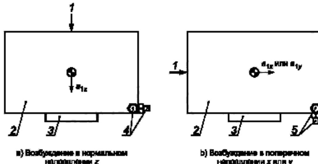
1 — вибровозбудитель, 2 — масса распределения возбуждения; 3 — входной фланец испытуемого объекта; 4 — нежелательная вибрация  $a'_{1x}$  и  $a'_{1y}$ ; 5 — нежелательная вибрация  $a'_{1z}$  и  $a'_{1y}$  или  $a'_{1x}$
