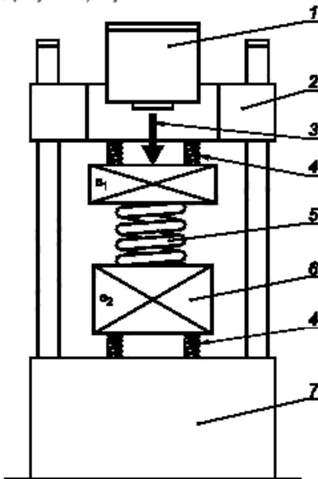
1 — вибровозбудитель; 2 — поперечина; 3 — толкатель; 4 — вспомогательные виброизоляторы; 5 — испытуемый объект; 6 — нагружающая масса; 7 — жесткое основание
