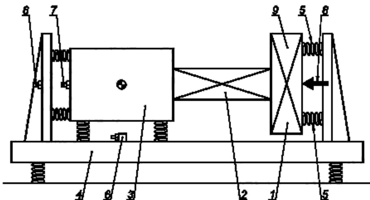
1 — масса распределения возбуждения; 2 — испытуемый объект; 3 — нагружающая масса; 4 — жесткое основание; 5 — вспомогательные виброизолаторы; 6 — акселерометр (измерение  $a_3$ ); 7 — акселерометр (измерение  $a_2$ ); 8 — динамическое возбуждение; 9 — акселерометр (измерение  $a_1$ )
