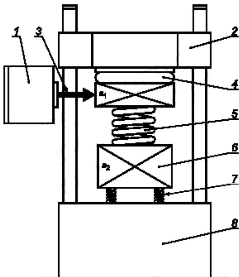
1 — вибровозбудитель; 2 — поперечина; 3 — толкатель; 4 — направляющая система; 5 — испытуемый объект; 6 — нагружающая масса; 7 — вспомогательный виброизолятатор; 8 — жесткое основание
