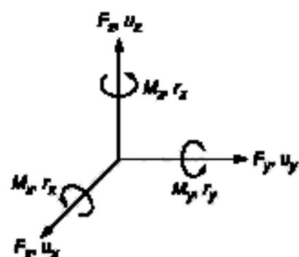
Рисунок А.1 — Декартовская система координат сил, моментов, перемещений и угловых перемещений
