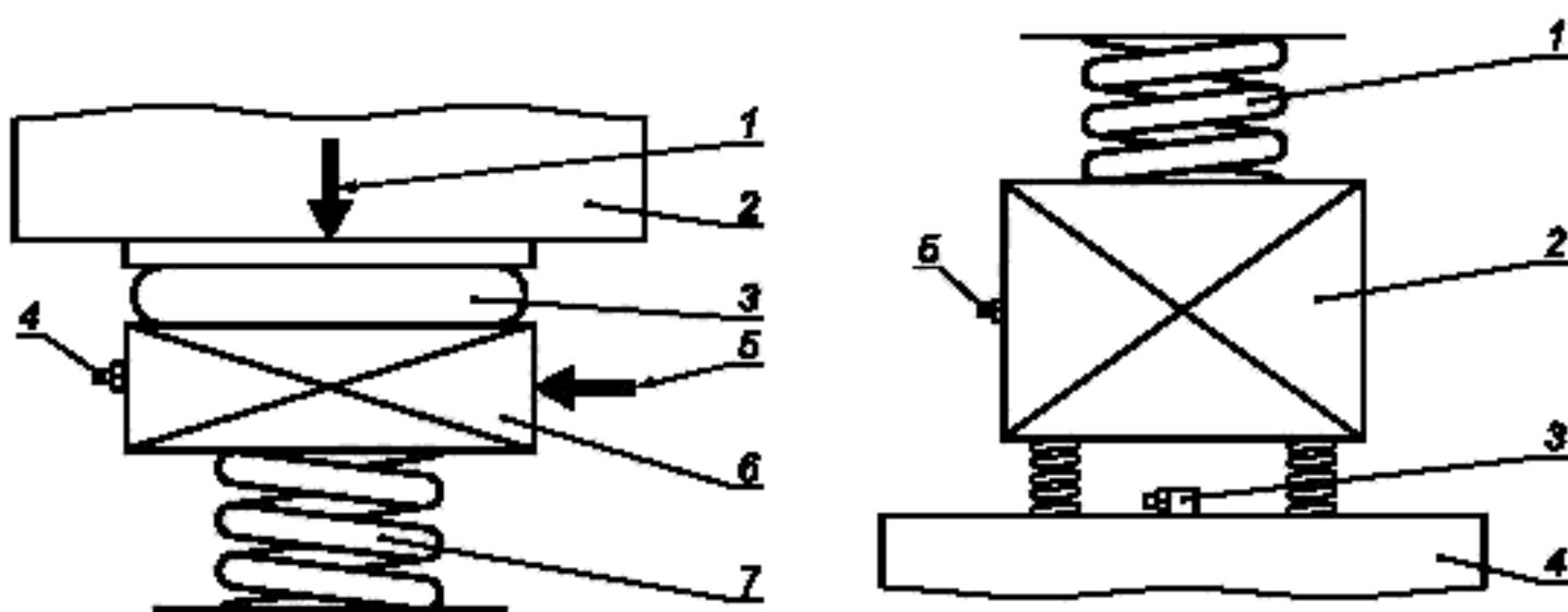
1 — статическая нагрузка; 2 — поперечина; 3 — направляющая система; 4 — акселерометр (измерение  $a_1$ ); 5 — динамическое возбуждение; 6 — масса распределения возбуждения; 7 — испытуемый объект
