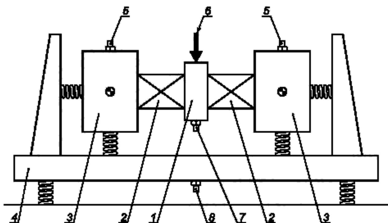
1 — масса распределения возбуждения; 2 — испытуемый объект; 3 — нагружающая масса; 4 — жесткое основание; 5 — акселерометр (измерение  $a_2$ ); 6 — динамическое возбуждение; 7 — акселерометр (измерение  $a_1$ ); 8 — акселерометр (измерение  $a_3$ )
