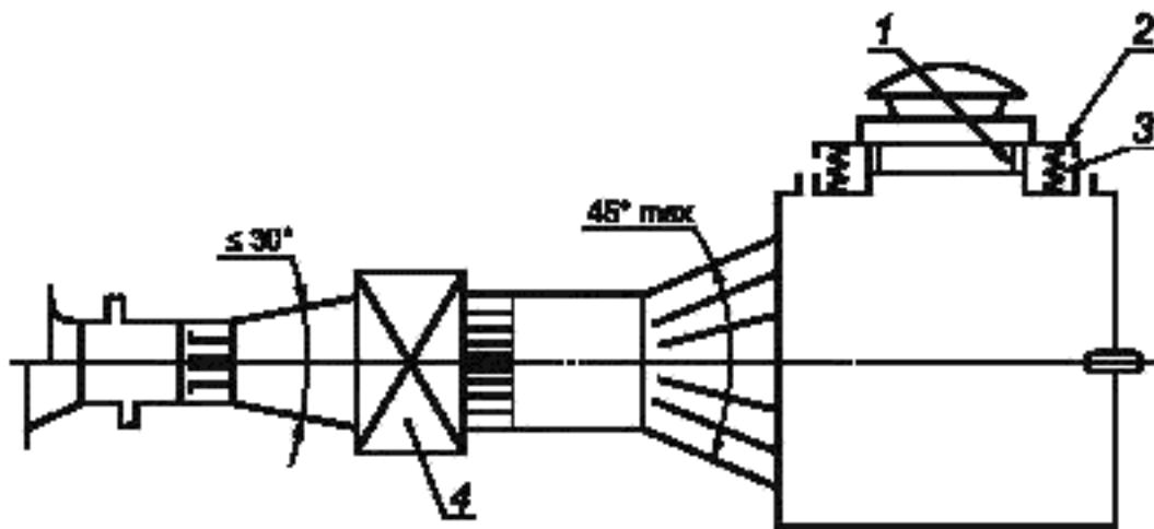
1 — гибкая вставка для испытаний; 2 — упруго закрепленный бордюр; 3 — упругая опора; 4 — вспомогательный вентилятор
