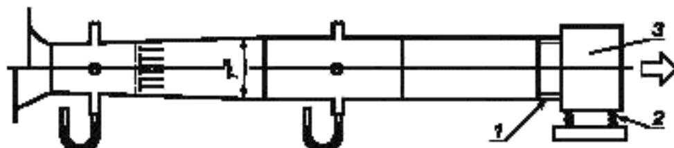
1 — гибкая вставка; 2 — упругая опора; 3 — вентилятор
