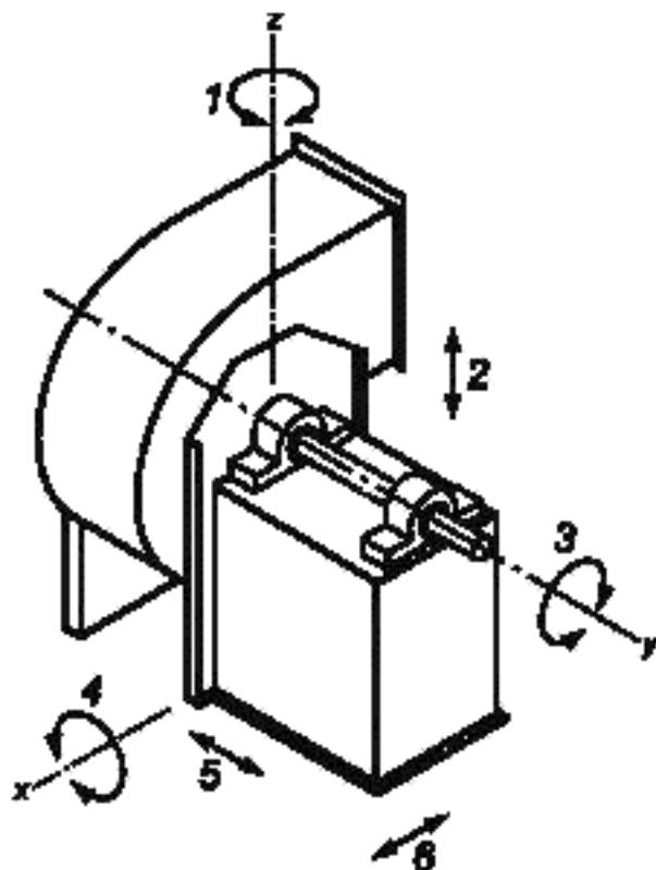
1 — колебания вокруг вертикальной оси  $z$ ; 2 — движение под действием вертикальных сил. 3 — хрупкие колебания вокруг оси  $y$ ; 4 — колебания вокруг оси  $x$ ; 5 — движение под действием продольных сил; 6 — движение под действием поперечных сил
