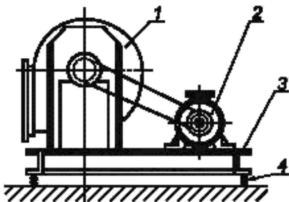
1 — радиальный вентилятор; 2 — двигатель; 3 — несущая рама, 4 — упругие опоры
