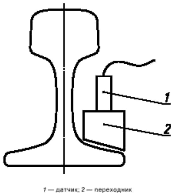
Рисунок 2 — Точка измерения на подошве рельса
