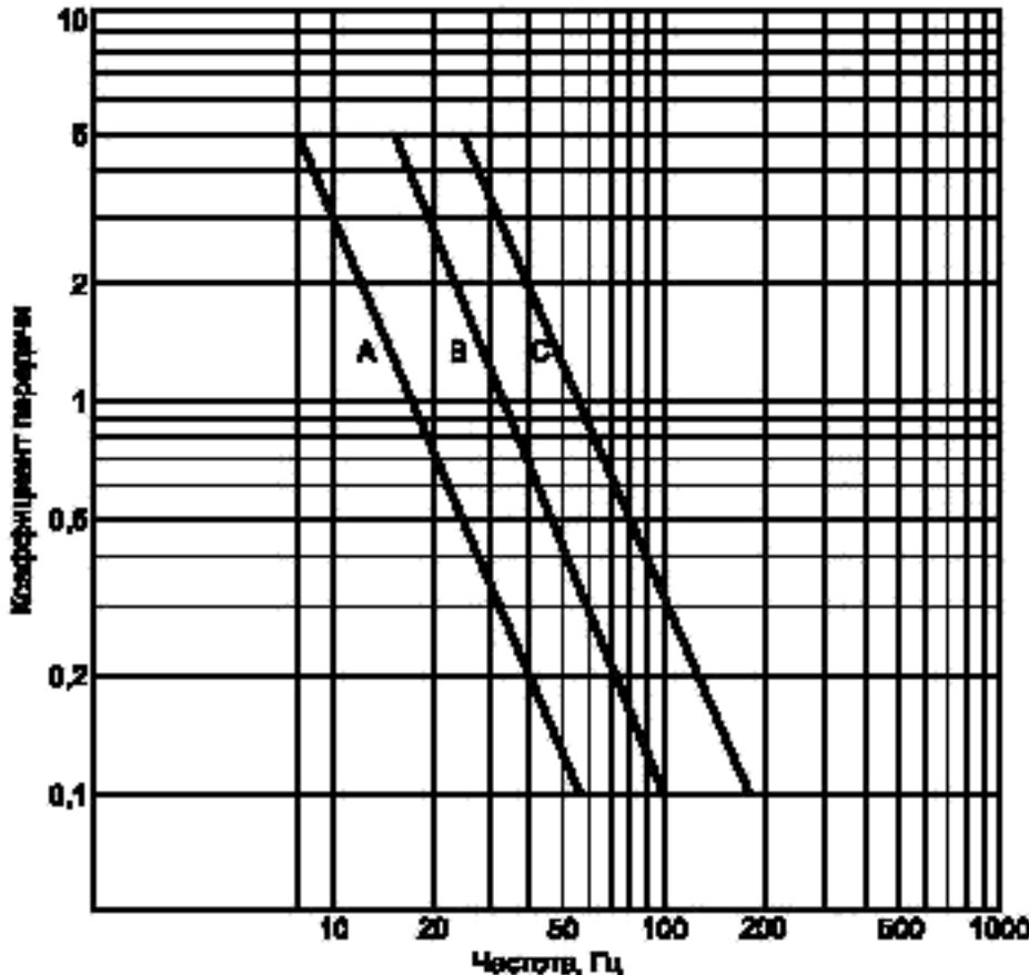
Рисунок А.6 — Коэффициент передачи виброизолятора
