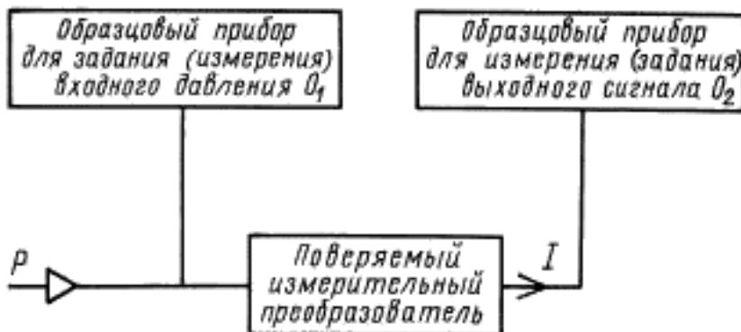
б) установкой по образцовому прибору  $O_2$  расчетного значения выходного сигнала, соответствующего заданному номинальному значению измеряемого давления, и измерением по другому образцовому прибору  $O_1$  действительного значения измеряемого давления.
