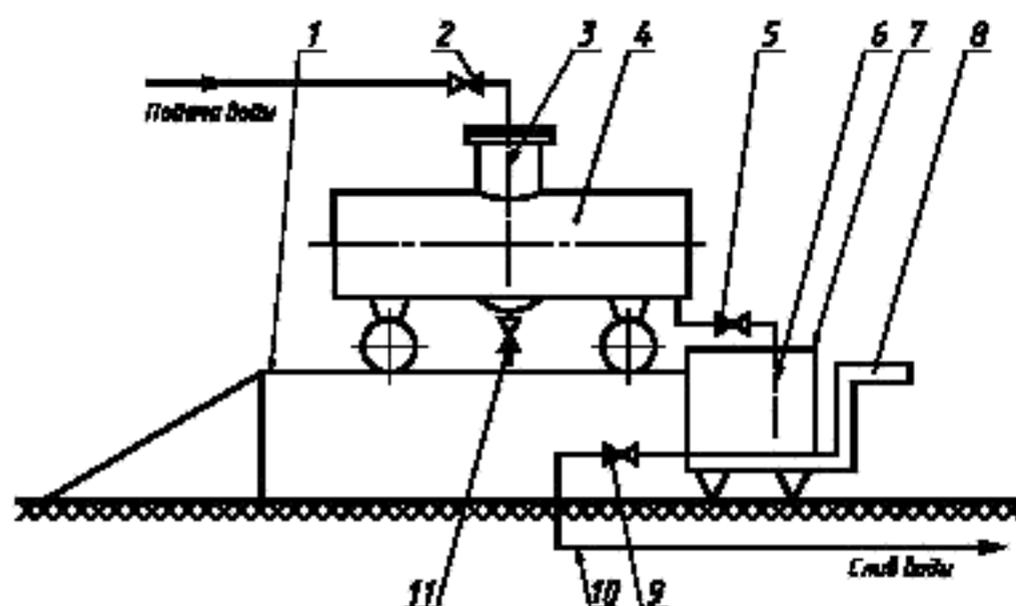
1 — эстакада; 2 — наливной кран; 3 — шланг; 4 — ТМ; 5, 9 — сливные краны; 6 — сливной шланг; 7 — вспомогательная тара; 8 — весы; 10 — сливной трубопровод; 11 — кран отстойника
