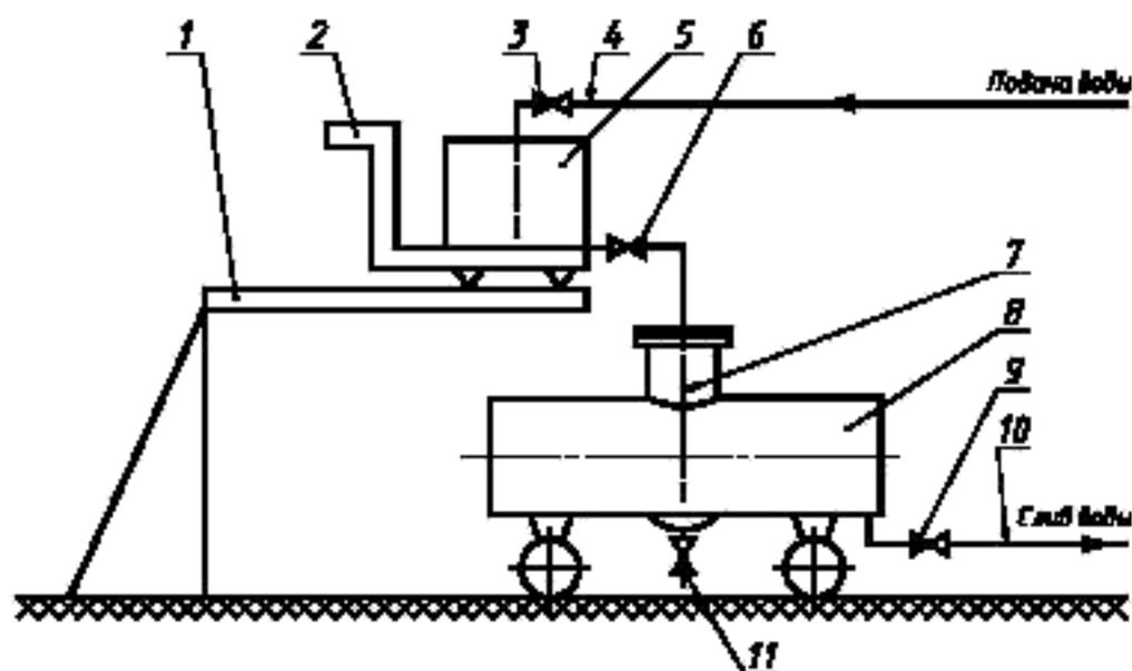
1 — эстакада; 2 — весы; 3 — наливной кран; 4 — наливной трубопровод; 5 — вспомогательная тара; 6, 9 — сливные краны; 7 — сливной шланг; 8 — ТМ; 10 — сливной трубопровод; 11 — кран отстойника
