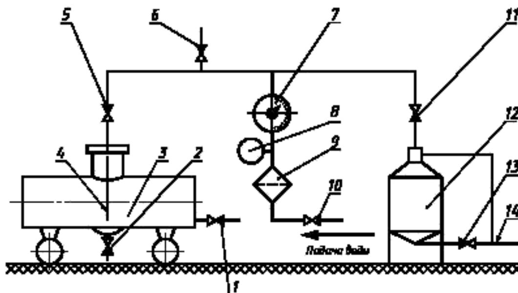
1, 5, 6, 11, 13 – краны; 2 – кран отстойника; 3 – ТМ; 4 – шланг; 7 – счетчик жидкости; 8 – манометр; 9 – фильтр;
