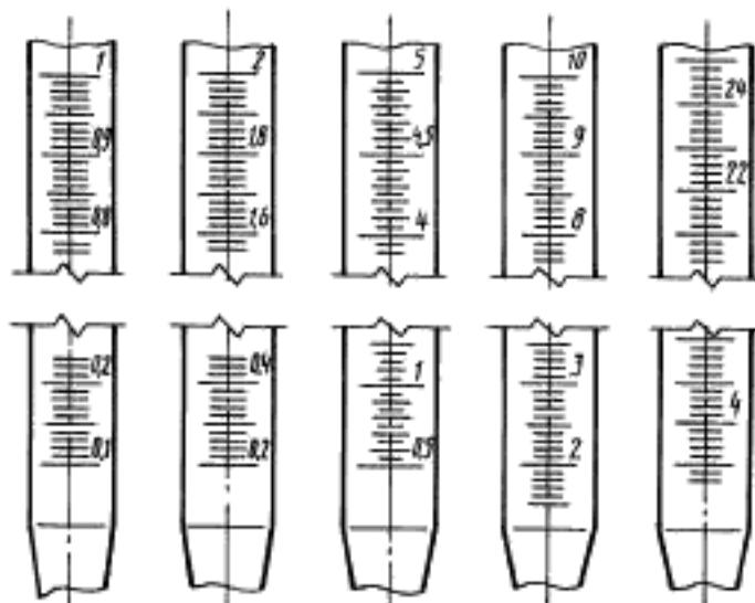
**П р и м е ч а н и е.** В практике применяют выдувные пипетки, градуированные так же, как и пипетки типа З по ГОСТ 29228, предназначенные для слива жидкости от верхней нулевой точки до требуемой отметки (при сливе жидкости — до сливного кончика).
