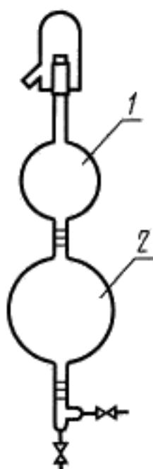
1 — резервуар вместимостью, равной вместимости части цилиндра до первой поверяемой отметки;
