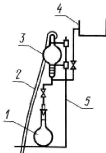
1 — поверненная колба; 2 — резиновая трубка; 3 — образцовая пипетка; 4 — резервуар для воды; 5 — штатив
