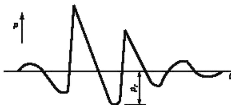
$p$  — акустическое давление,  $t$  — время;  $p_r$  — пиковое акустическое давление разреза
