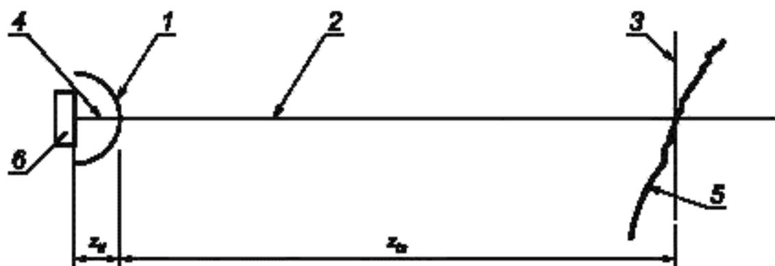
$z_H$  — расстояние между преобразователем и выходной поверхностью датчика;  $z_{LS}$  — расстояние установки датчика;
