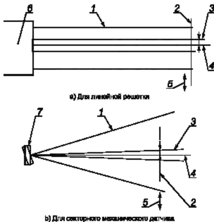
1 — линия ультразвукового сканирования; 2 — заданная плоскость (плоскость измерений); 3 — разделение линий ультразвукового сканирования; 4 — центральная линия сканирования; 5 — направление сканирования; 6 — датчик с решеткой линейного сканирования; 7 — механический датчик секторного сканирования
