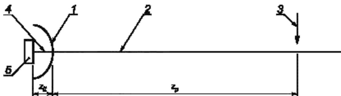
$z_H$  — расстояние между преобразователем и внешней поверхностью датчика;  $z_P$  — расстояние между внешней поверхностью датчика и точкой максимального интеграла квадратов давления в импульсе;
