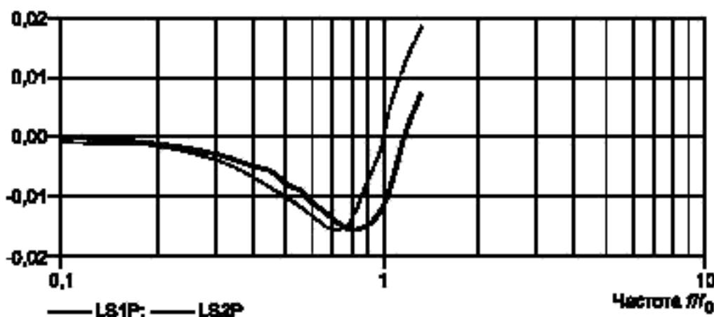
Рисунок Г.2 — Общий вид зависимости температурного коэффициента от частоты для микрофонов типов LS1P и LS2P, вызванной изменением импеданса замкнутого объема воздуха
