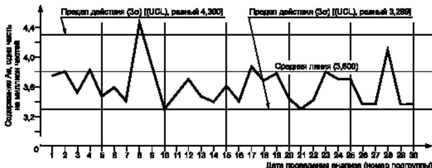
Рисунок 11 — Контрольная карта Шухарта для средних значений  $\bar{x}$  содержания мышьяка в оксиде цинка
