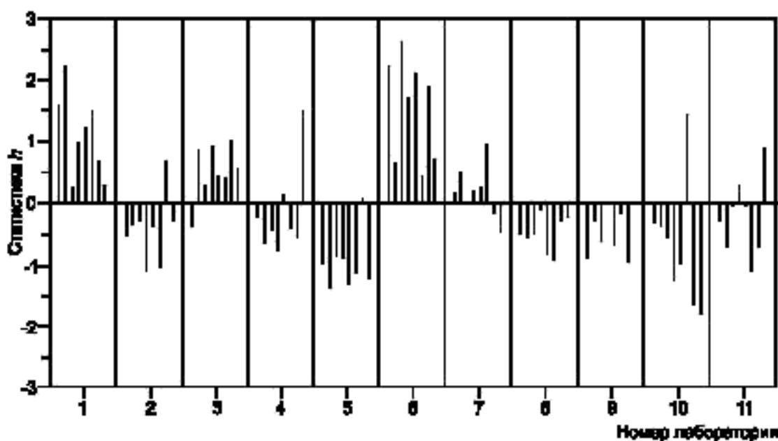
Рисунок 7 — Пример 2. Проверка совместности средних значений в элементах (сгруппированных по лабораториям)
