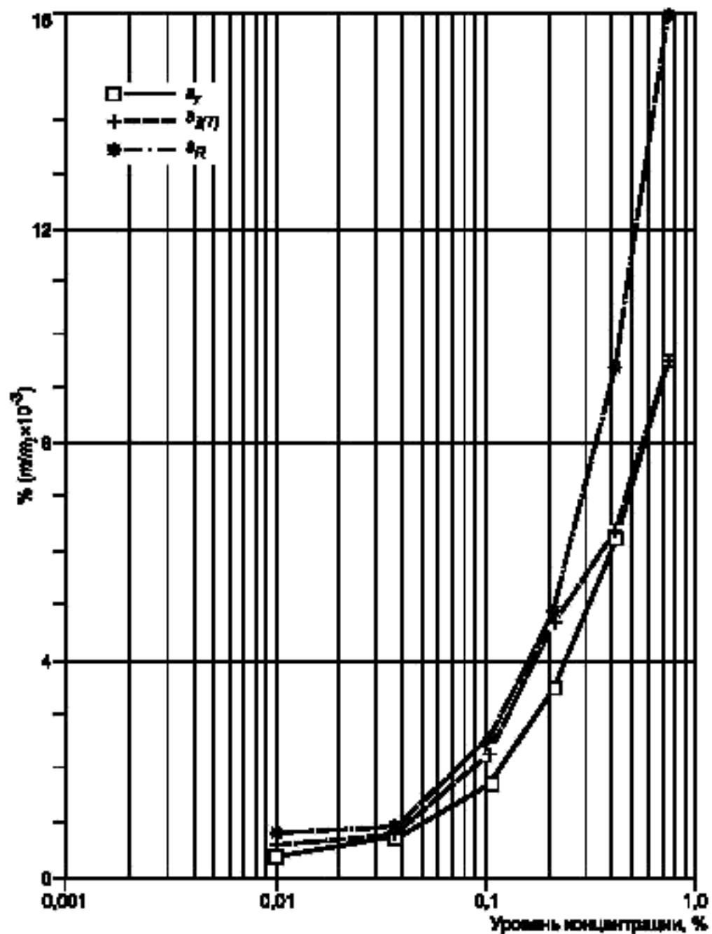
Рисунок D.3 — Содержание ванадия в стали. Стандартные отклонения повторяемости  $s_r$ , промежуточной прецизионности с изменяющимся фактором времени  $s_{I(T)}$  и воспроизводимости  $s_R$  как функции уровня концентрации
