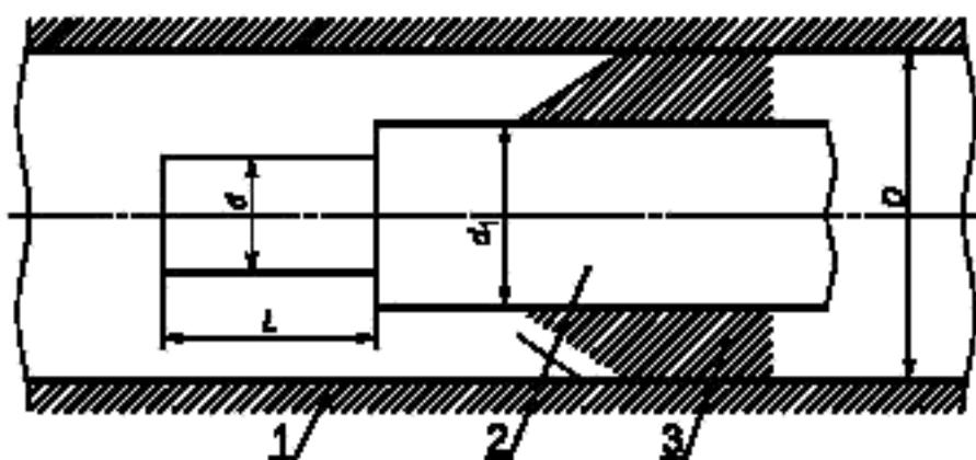
1 — внешний проводник; 2 — внутренний проводник (для согласованных и короткозамкнутых нагрузок с переменной фазой для внутреннего проводника  $d = d_1$ ); 3 — поглотитель;  $d$ ,  $d_1$  — диаметры внутреннего проводника;  $D$  — диаметр внешнего проводника;  $L$  — фазосдвигающий участок
