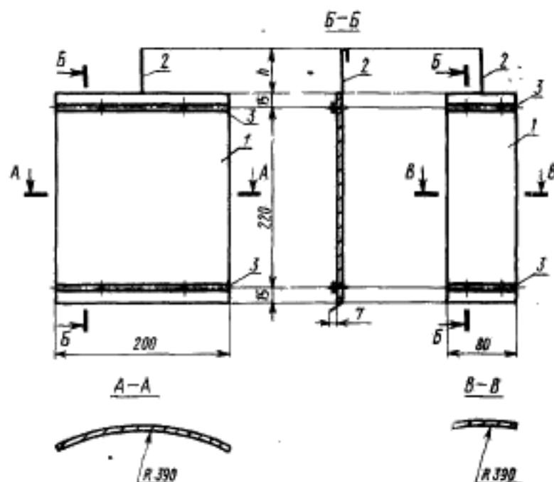
1—кассета, изогнутая по кривизне барабана; 2—подвеска кассеты; 3—пластинка для крепления образца; 7—высота подвески в соответствии с размерами зоны облучения.
