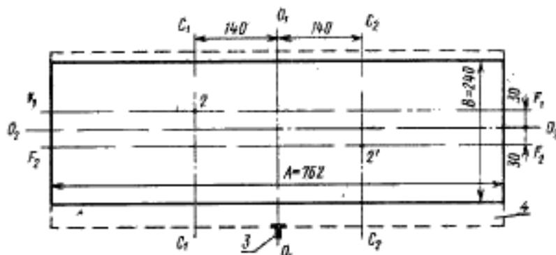
1—трубчатая ксеноновая лампа; 2, 2'—центры угольных дуговых ламп (дуги); 3—крестовина вала барабана; 4—расположенный барабан; А—расстояние между протвележащими образцами, расположенными в вертикальных плоскостях; В—высота зоны облучения;  $O_1O_2$ —вертикальная ось симметрии зоны облучения;  $O_1O_2$ —горизонтальная ось симметрии зоны облучения;  $C_1C_2$  и  $C_1'C_2'$ —оси первого и второго источников облучения;  $F_1F_1'$  и  $F_2F_2'$ —линии центров угольных дуговых ламп.
