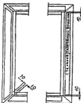
Рисунок 6 — Примеры установки усиливательных вкладышей
