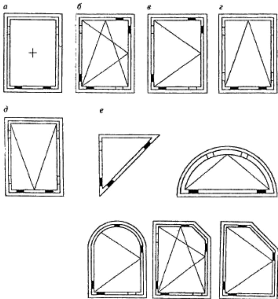
Виды открывания оконных блоков: *а* — неоткрывающиеся; *б* — поворотно-откидное; *в* — поворотное (распашное); *г* — откидное; *д* — подвесное, *е* — установка подкладок в фигурных оконных блоках
