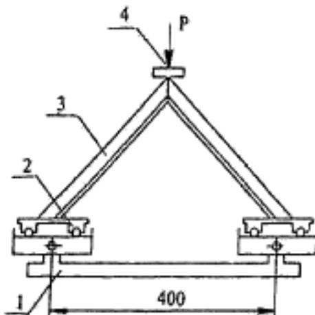
1 — опора; 2 — упор (для схемы Б — каретки); 3 — образец; 4 — точка приложения нагрузки; 5 — съемные хомуты крепления
