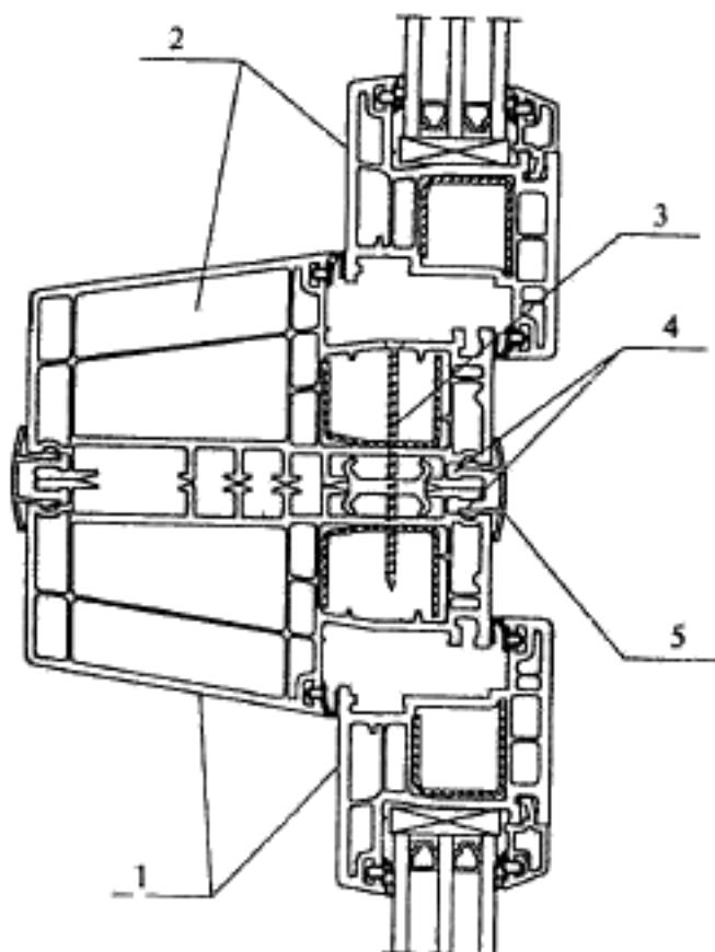
1 — оконный блок; 2 — дверной балконный блок; 3 — стяжной шуруп; 4 — силиконовый герметик; 5 — нашельник
