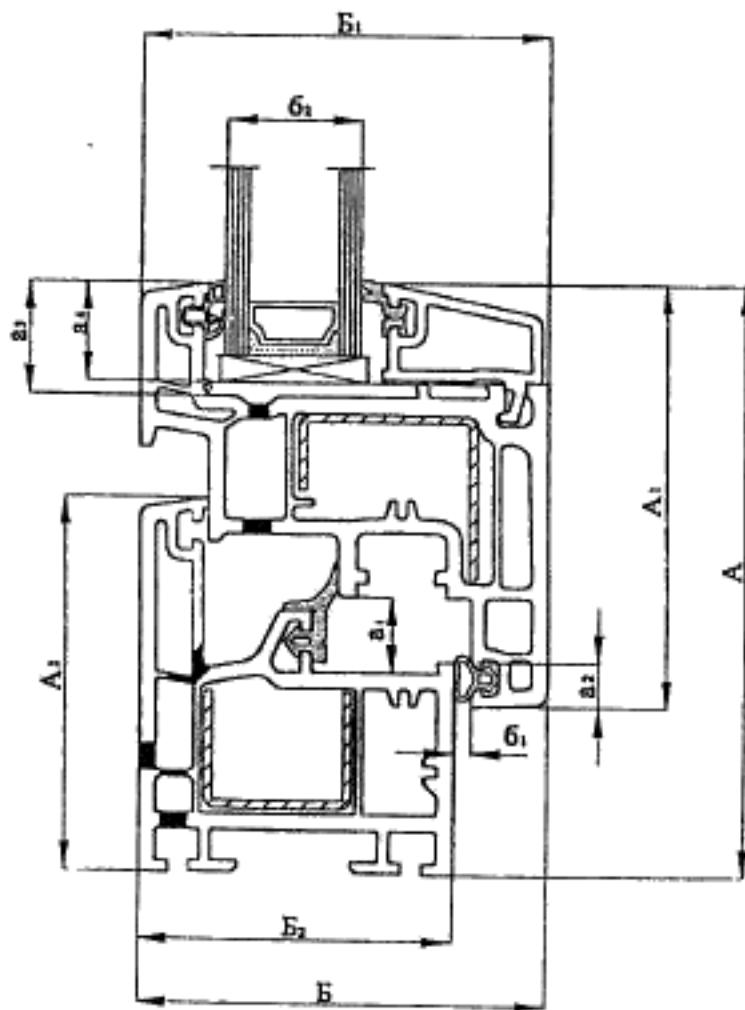
$A$  — высота комбинации профилей;  $A_1$  — высота профиля створки;  $A_2$  — высота профиля коробки;  $B$  — ширина комбинации профилей;  $B_1$  — ширина профиля створки;  $B_2$  — ширина профиля коробки;  $a_1$  — размер фальцлюфта (зазор в притворе);  $a_2$  — размер притвора под наплавом;  $a_3$  — высота фальца (четверти) остекления;  $a_4$  — высота защемления стеклопакета;  $b_1$  — размер зазора под наплавом;  $b_2$  — толщина стеклопакета
