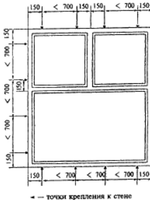
*Рисунок Г.3 — Расположение крепежных деталей*
