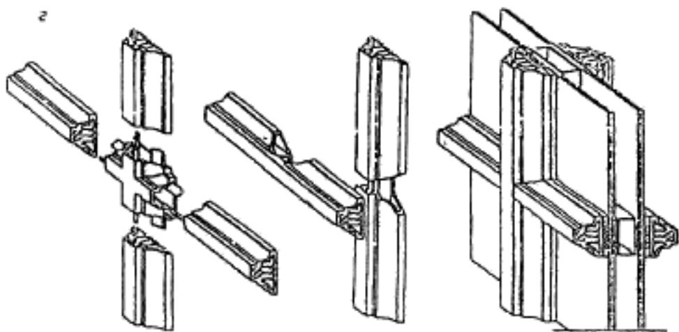
*а* — профили внутренней рамки стеклопакета; *б* — накладные декоративные раскладки; *в* — вариант комбинированного применения накладных раскладок и внутренней рамки стеклопакета; *г* — переплетные соединения раскладок
