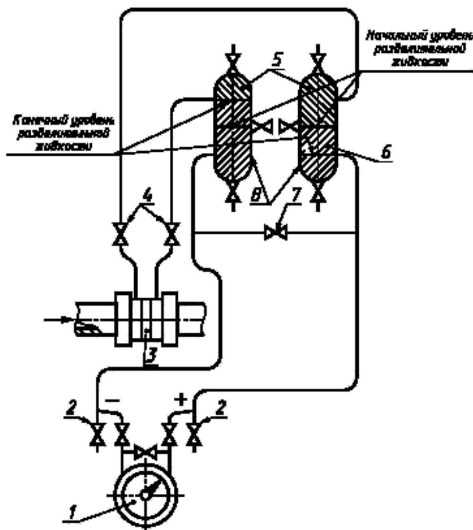
1 — ППД; 2 — продувочный вентиль; 3 — СУ; 4 — кран; 5 — измеряемый газ; 6 — разделительная жидкость;
