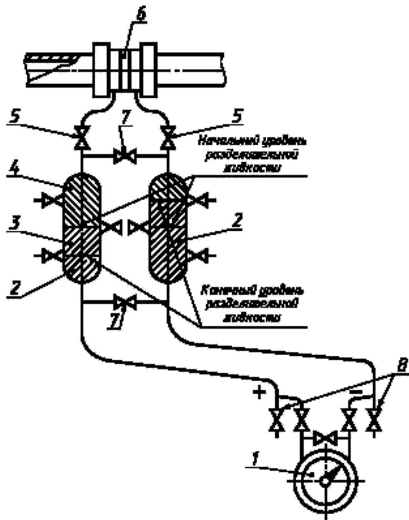
1 — ППД; 2 — разделительный сосуд; 3 — разделительная жидкость; 4 — измеряемая жидкость; 5 — кран; 6 — СУ;
