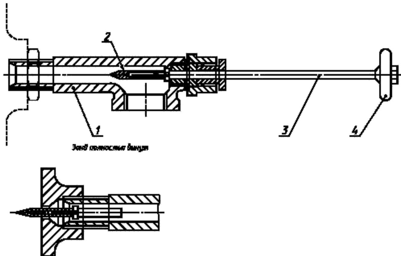
1 — корпус; 2 — головка зонда; 3 — ось зонда; 4 — рукоятка
