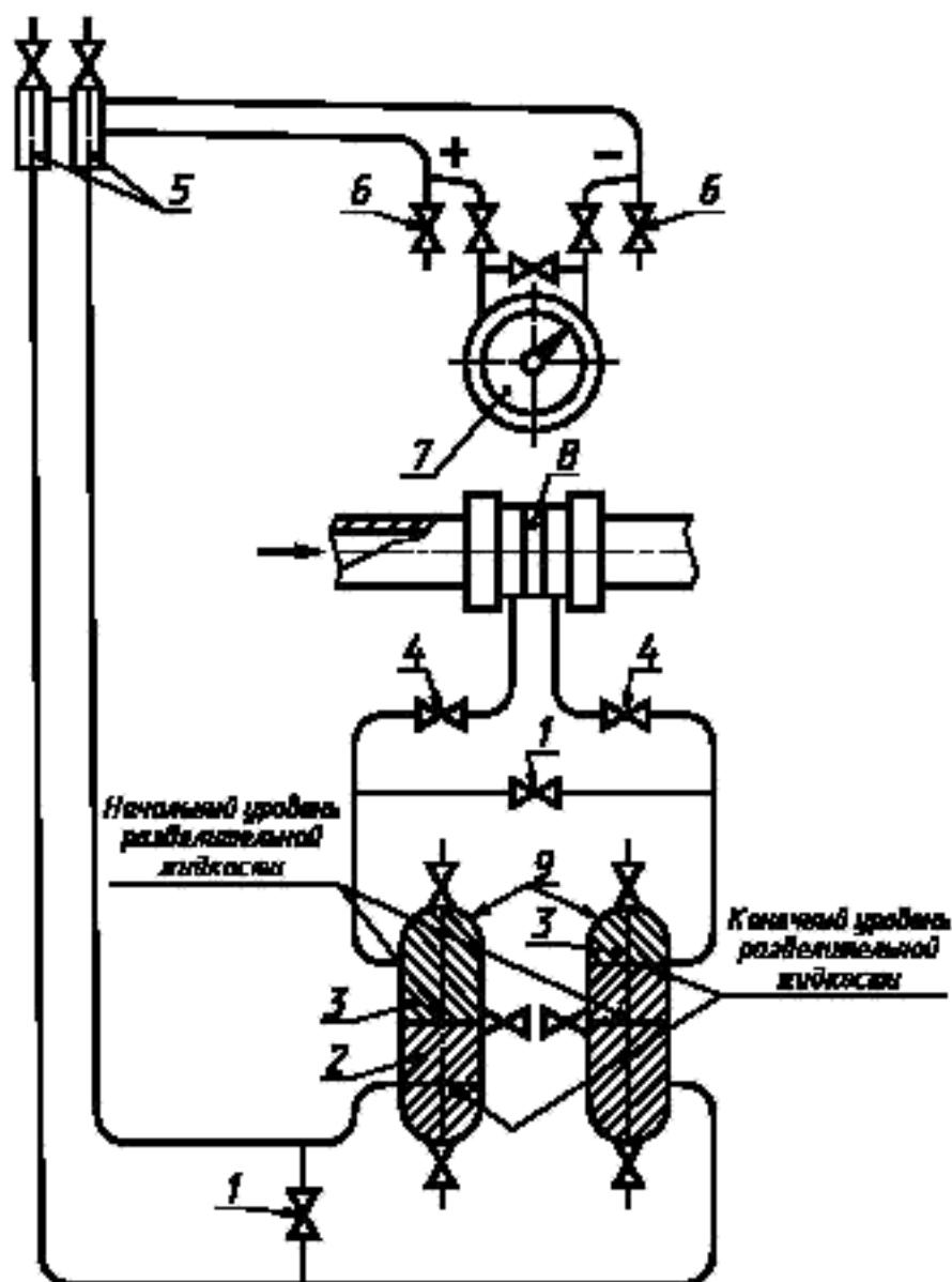
1 — уравнительный вентиль; 2 — разделительная жидкость; 3 — измеряемая жидкость; 4 — кран; 5 — газосборник;
