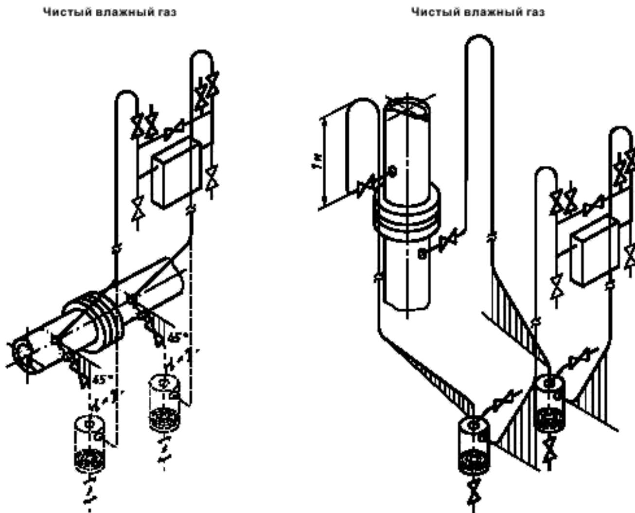
Рисунок Г.11 — ППД над трубопроводом
