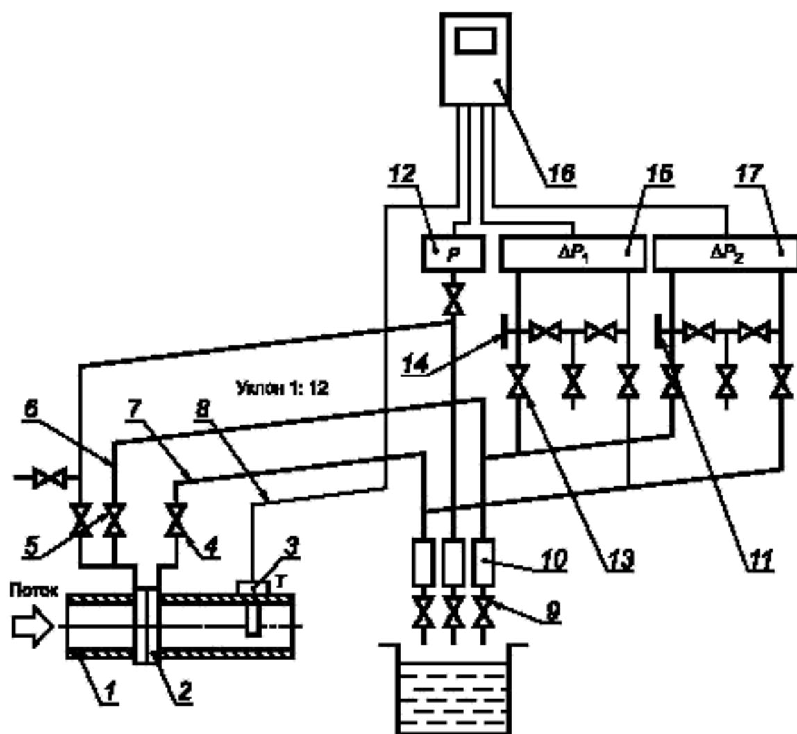
1 — измерительный трубопровод; 2 — СУ; 3 — датчик температуры; 4, 5 — отсечные вентили; 6, 7 — соединительные линии; 8 — кабель для соединения датчика температуры с вычислителем; 9 — дренажные вентили; 10 — конденсатосборники; 11 — заглушка; 12 — датчик давления; 13 — вентильный блок; 14 — штуцер со съемной резьбой; 15 — основной дифманометр; 16 — вычислитель; 17 — дополнительный дифманометр.
