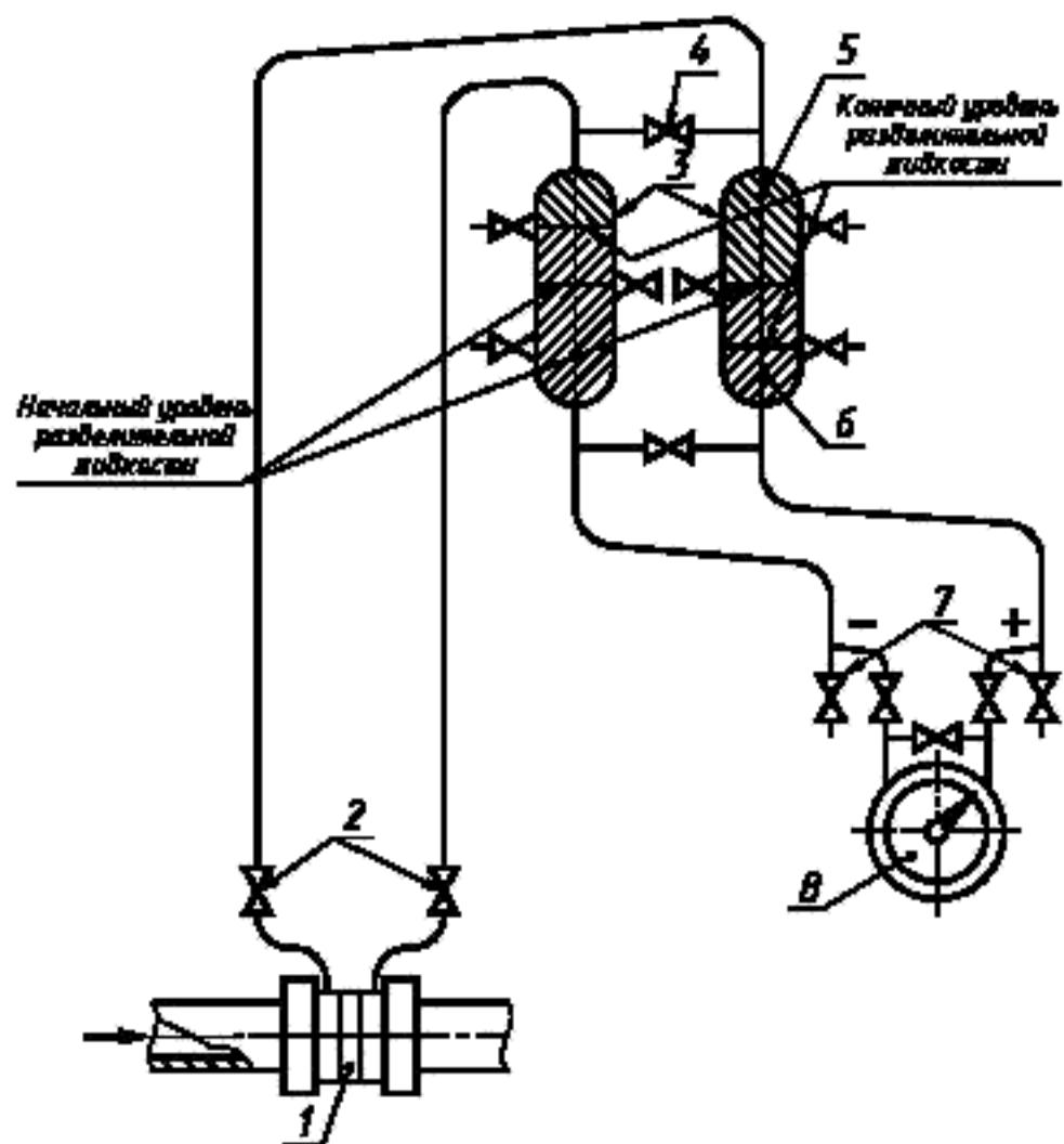
1 — СУ; 2 — кран СУ; 3 — разделительный сосуд; 4 — уравнительный вентиль; 5 — измеряемый газ;
