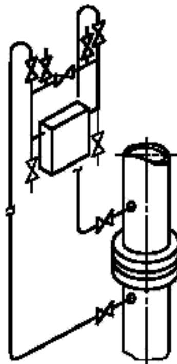
Рисунок Г.1 — ППД над трубопроводом.
