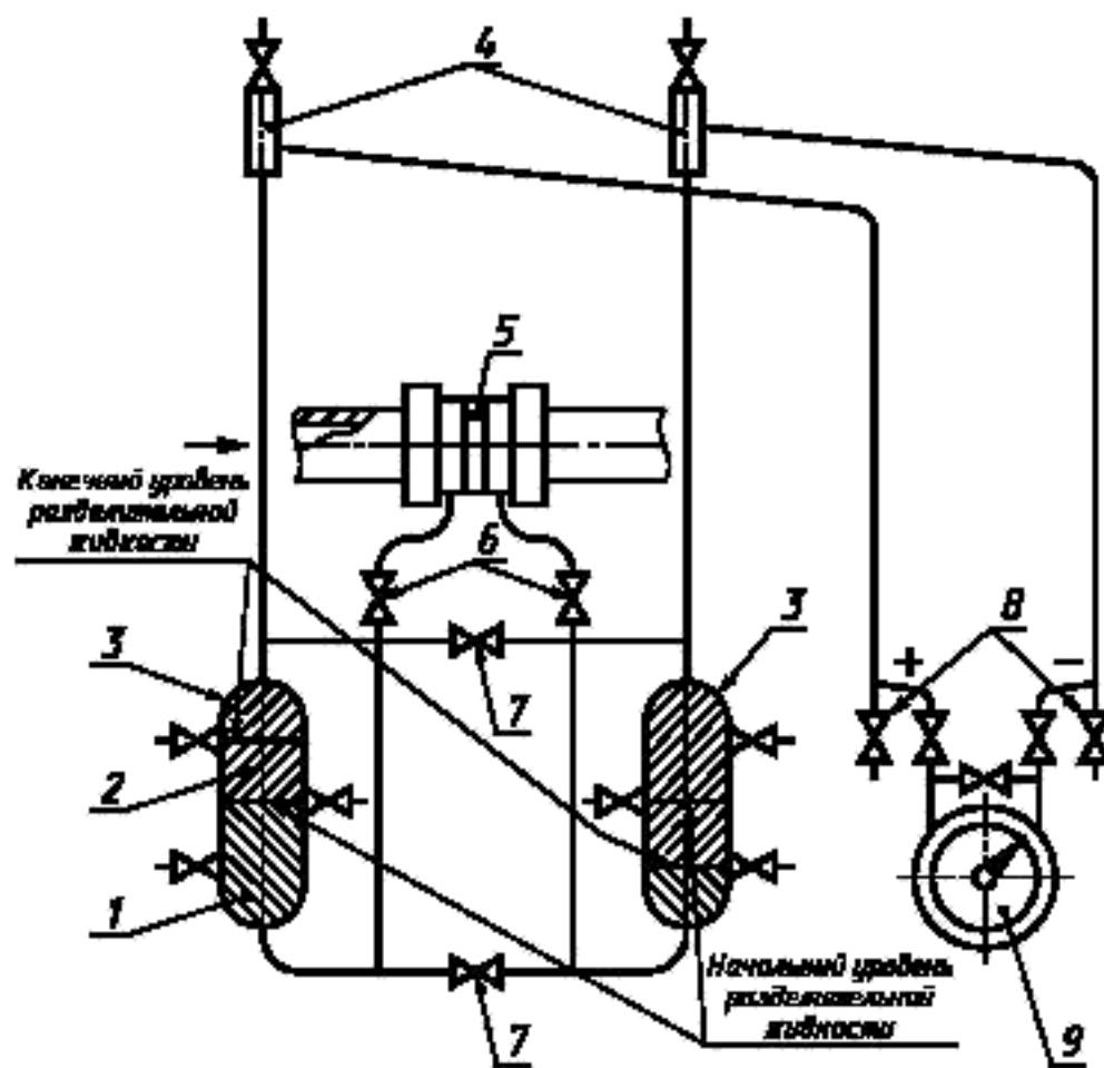
1 — измеряемая жидкость; 2 — разделительная жидкость; 3 — разделительный сосуд; 4 — газосборник; 5 — СУ;
