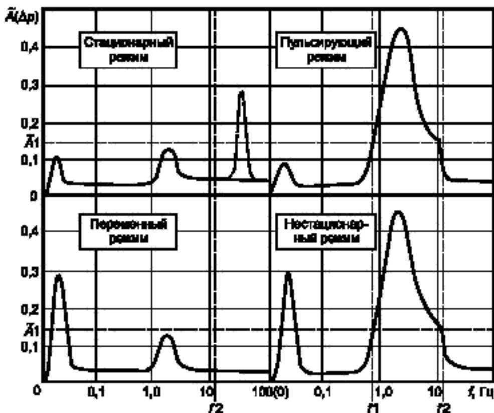
Рисунок Ж.1 — Характерные виды АЧС  $\Delta r(\omega)$  на диафрагме при нестационарном потоке природного газа
