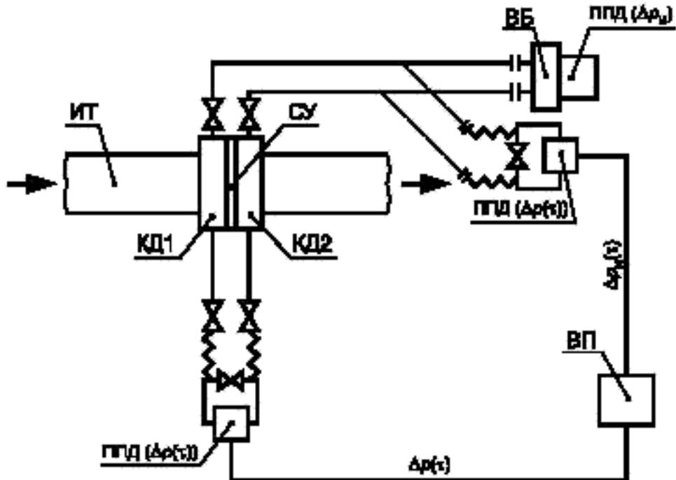
КД1,2 — камеры отбора давления; ППД ( $\Delta p(t)$ ) — СИ перепада давления, применяемое для испытаний; ППД ( $\Delta p_u$ ) — СИ перепада давления, входящее в комплект технических средств, применяемых для определения расхода и количества среды
