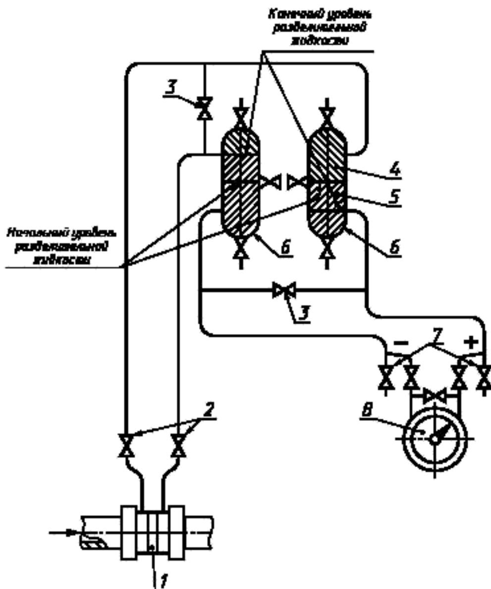
1 — СУ; 2 — кран; 3 — уравнительный вентиль; 4 — измеряемый газ; 5 — разделительная жидкость;
