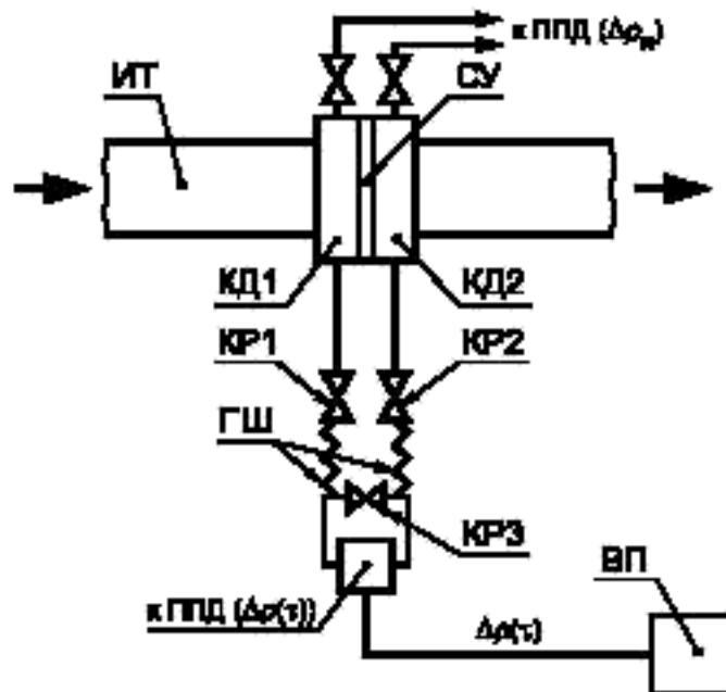
КД1,2 — камеры отбора давления; КР1,2 — разделительные краны; КР3 — уравнительный кран; ГШ — бронированные шланги; ППД ( $\Delta r_s$ ) — СИ перепада давления, применяемое для испытаний; ППД ( $\Delta r_p$ ) — СИ перепада давления, входящее в комплект технических средств, применяемых для определения расхода и количества среды
