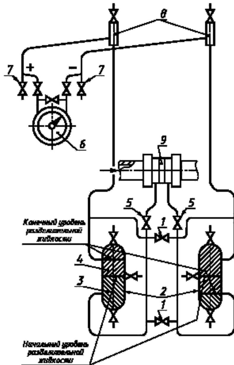
1 — уравнительный вентиль; 2 — разделительный сосуд; 3 — измеряемая жидкость; 4 — разделяемая жидкость;
