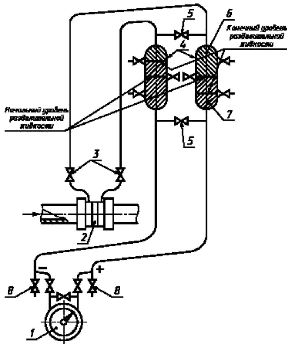
1 — ППД; 2 — СУ; 3 — кран; 4 — разделительный сосуд; 5 — уравнительный вентиль; 6 — измеряемый газ;
