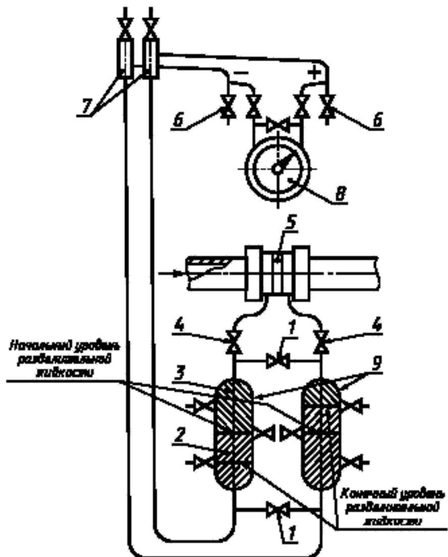
1 — уравнительный вентиль; 2 — разделительная жидкость; 3 — измеряемая жидкость; 4 — кран; 5 — СУ;
