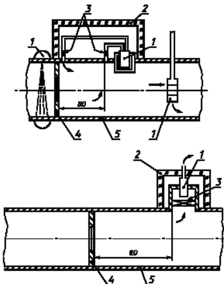
1 — плотномер; 2 — теплоизоляция; 3 — вентиль, 4 — сужающее устройство; 5 — трубопровод.
