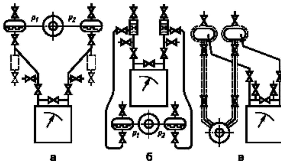
Рисунок 3 — Схемы расположения уравнительных сосудов и соединительных трубок
