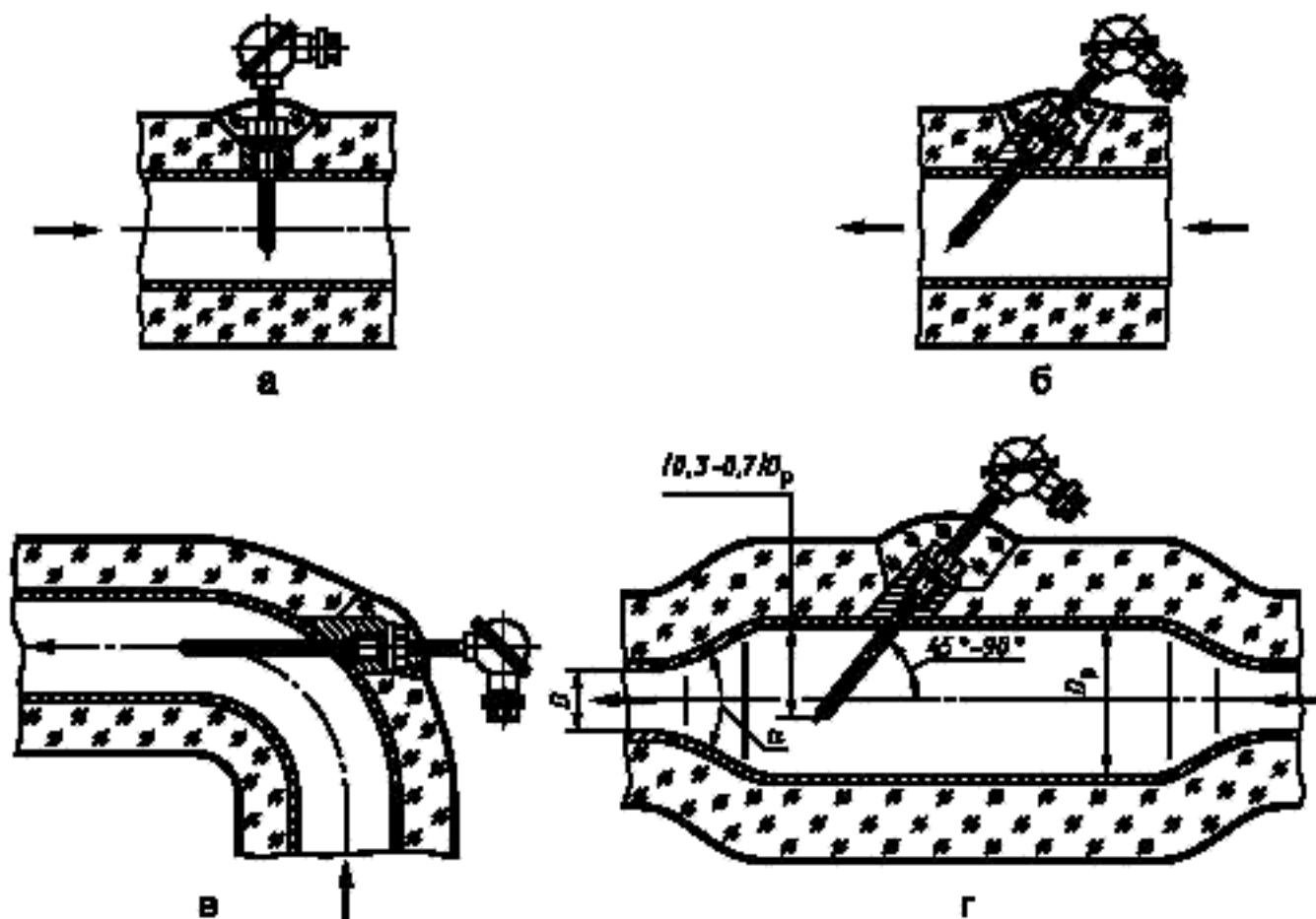
Рисунок 11 — Схема установки ПТ
