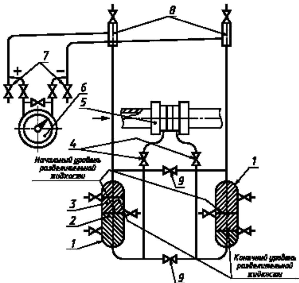
1 — разделительный сосуд; 2 — измеряемая жидкость; 3 — разделительная жидкость; 4 — кран; 5 — СУ; 6 — ППД;
