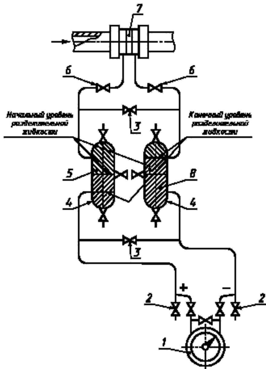
1 — ППД; 2 — продувочный вентиль; 3 — уравнительный вентиль; 4 — разделительный сосуд; 5 — измеряемая жидкость;
