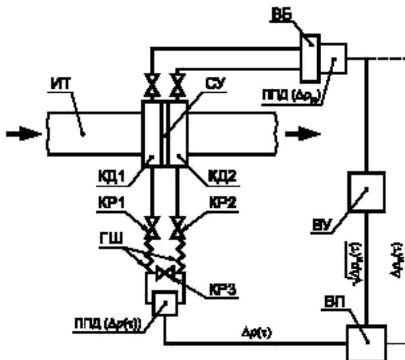
КД1,2 — камеры отбора давления; KP1,2 — разделительные краны; KP3 — уравнительный кран; ГШ — бронированные шланги; ППД ( $\Delta p(t)$ ) — СИ перепада давления, применяемое для испытаний; ППД ( $\Delta p_\mu$ ) — СИ перепада давления, входящее в комплект технических средств, применяемых для определения расхода и количества среды
