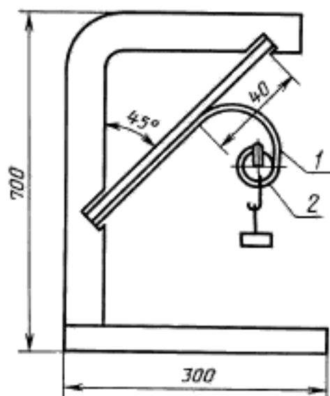
1 — испытательное покрытие; 2 — зажимное устройство
