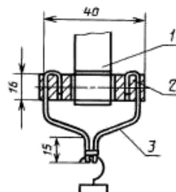
1 — испытательное покрытие; 2 — оправка; 3 — захват
