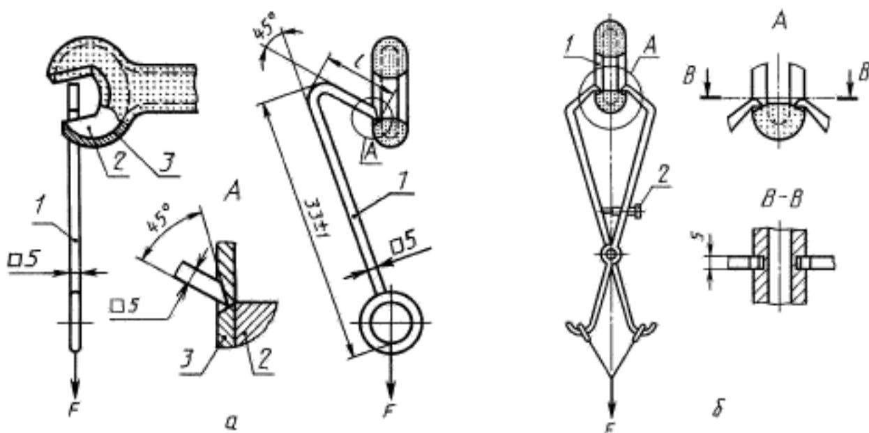
*α* — метод А — Испытание рабочей части инструмента: *1* — крюк (его длина зависит от размеров инструмента); *2* — проводящие части; *3* — изолирующее покрытие; *l* — длина изогнутой части крюка; *β* — метод Б — Испытания рабочей части инструмента: *1* — деталь А; *2* — регулирующее устройство
