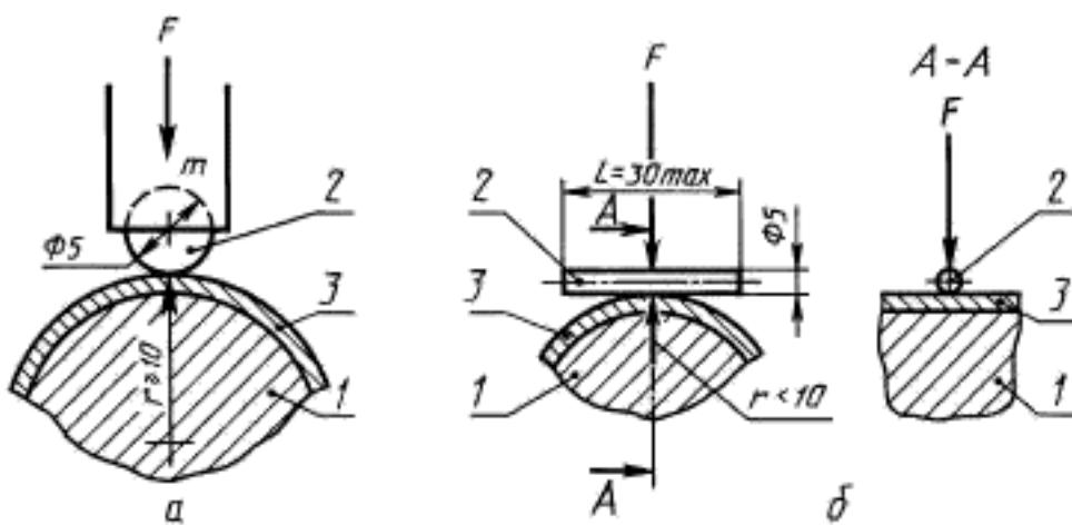
*α* — радиус прогиба инструмента в точке испытания  $\geq 10$  мм; *1* — проводящая часть; *2* — полусферическая деталь; *3* — изоляция (в испытуемой точке); *r* — радиус прогиба инструмента в месте испытания; *m* — масса, воздействующая на инструмент при испытании; *β* — радиус прогиба инструмента в точке испытания  $< 10$  мм; *1* — проводящая часть; *2* — цилиндрический стержень; *3* — изоляция (в испытуемой точке); *r* — радиус прогиба инструмента в месте испытания
