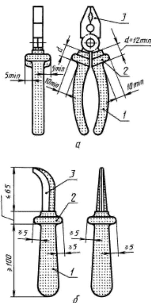
1 — изолированная ручка (или рукоятка); 2 — предохранительный упор; 3 — рабочая головка (неизолированная);
