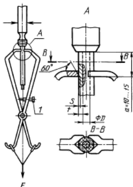
*J* — регулирующее устройство; *S* — глубина проникания (*S* = 0,5 *t* max); *t* — толщина изолирующего покрытия; *F* — прикладываемая сила; *a* — расстояние между точкой приложения режущей кромки испытательного устройства и соединением рукоятки со стержнем
