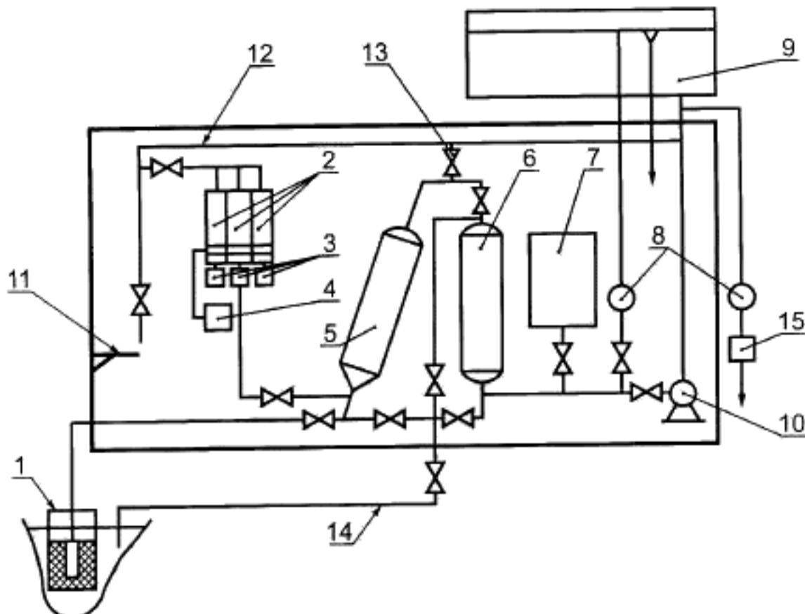
1 — водозаборное устройство с насосом; 2 — баки для приготовления растворов реагентов; 3 — дозирующие устройства; 4 — компрессор; 5 — тонкослойный отстойник с камерой хлопьесборования; 6 — фильтр; 7 — блок обеззараживания; 8 — расходомер; 9 — резервуар питьевой воды 1—2 шт.; 10 — промывной насос; 11 — рабочий стол; 12 — чистая вода на собственные нужды; 13 — устройство для выпуска воздуха из системы; 14 — водосток; 15 — водоразборный узел
