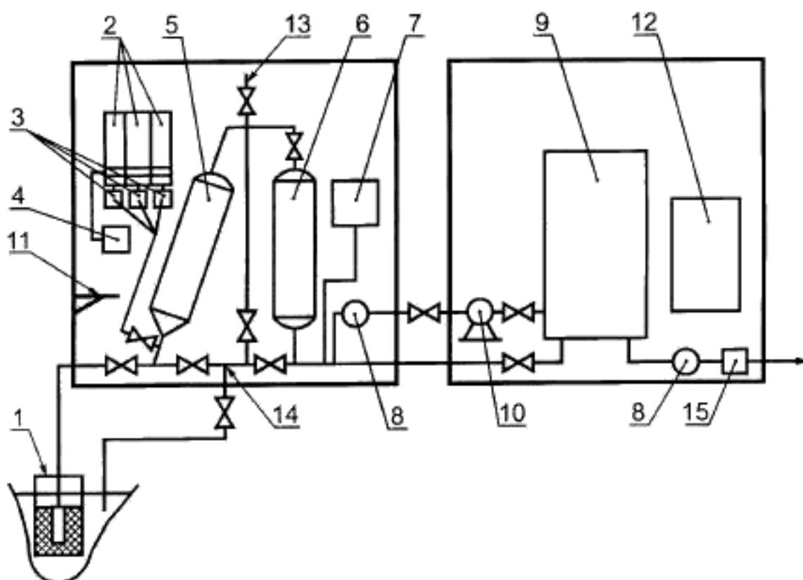
1 — водозаборное устройство с насосом; 2 — баки для приготовления растворов реагентов; 3 — дозирующие устройства; 4 — компрессор; 5 — тонкослойный отстойник с камерой хлопьесбора; 6 — фильтр; 7 — блок обеззараживания; 8 — расходомер; 9 — резервуар питьевой воды; 10 — промывной насос; 11 — рабочий стол; 12 — электрогенератор; 13 — устройство для выпуска воздуха из системы; 14 — водосток, 15 — водоразборный узел
