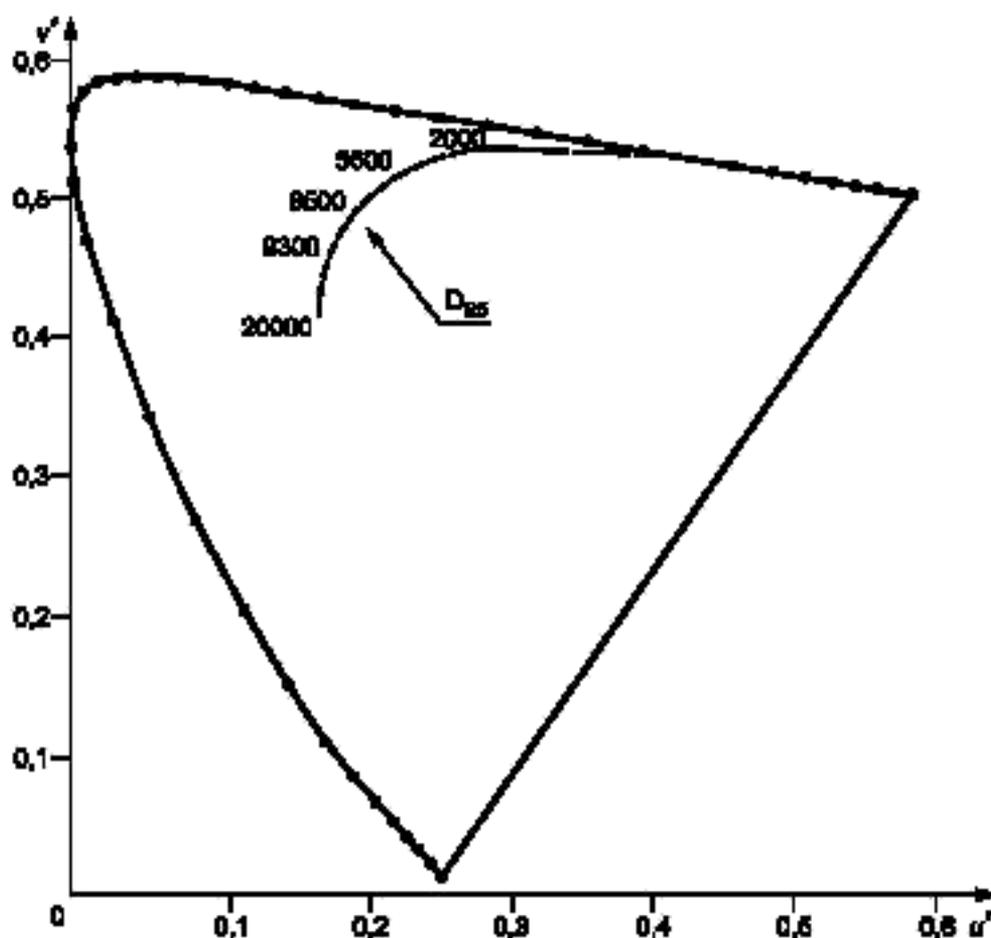
Рисунок 2 — Положение иллюминанта МКО D<sub>65</sub> и цветных температур на равноконтрастном цветовом графике МКО 1976 г.
