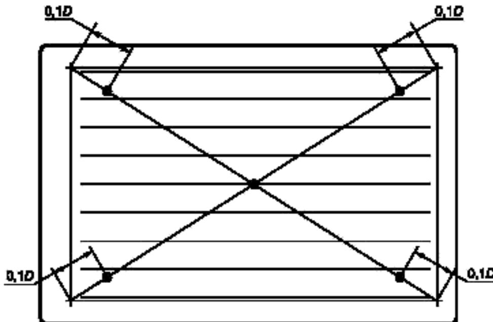
Примечание — На рисунке показаны пять мест измерений: в центре экрана в точке пересечения диагоналей (длина диагонали  $D$ ) области адресации дисплея и в точках на диагоналях, удаленных на  $0,1D$  длины диагоналей от углов области адресации дисплея.
