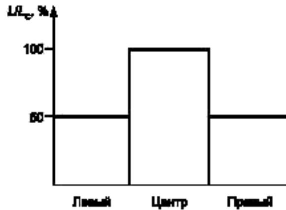
Рисунок 9 — Соотношение яркостей испытательной таблицы
