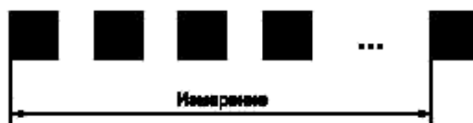
Рисунок 34 — Пример измерения шага пикселей
