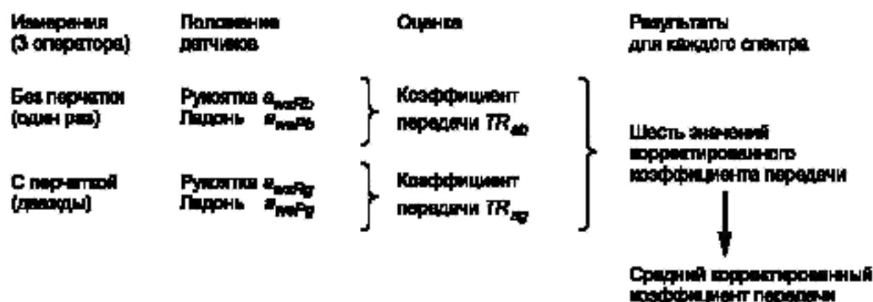
Рисунок 7 — Схема определения среднего корректированного коэффициента передачи
