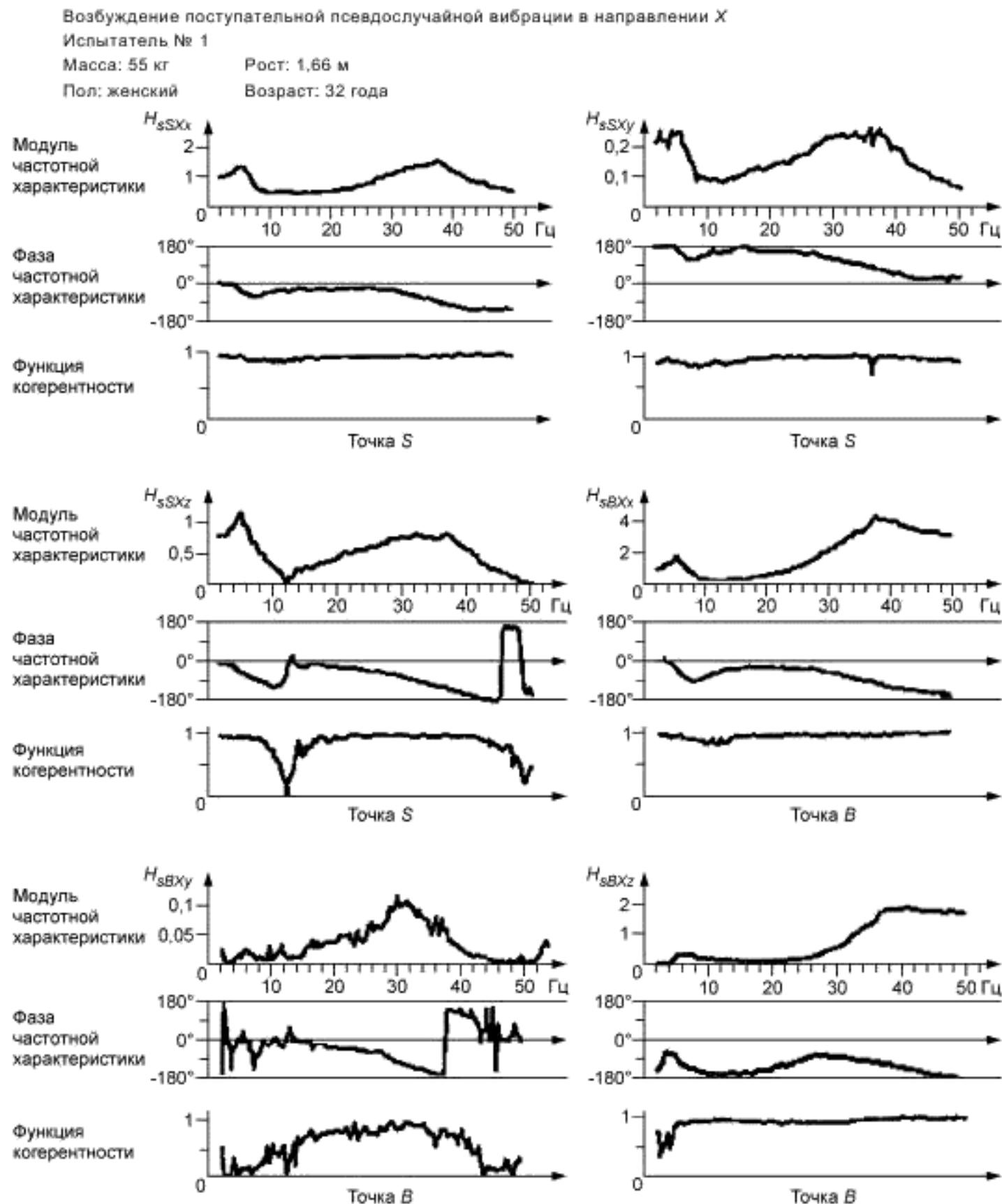
Рисунок 4 — Пример результатов испытания с возбуждением псевдослучайной вибрации
