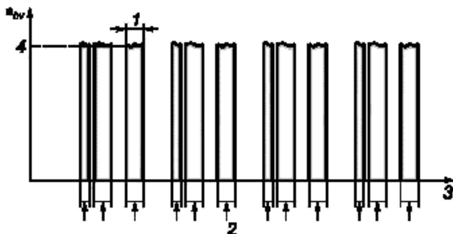
1 — длительность измерений; 2 — время воздействия вибрации (в данном случае общее время работы инструмента); 3 — время; 4 —  $a_{hv, \text{名义值}}$
