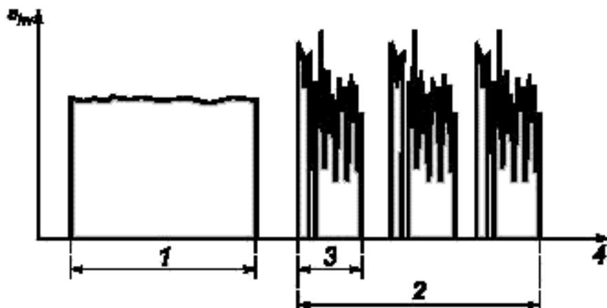
1 — инструмент 1; 2 — инструмент 2; 3 — рабочий цикл; 4 — время
