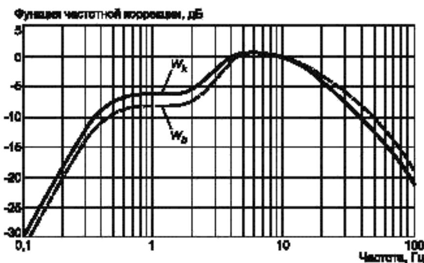
Рисунок 2 — Функции частотной коррекции  $W_b$  и  $W_k$
