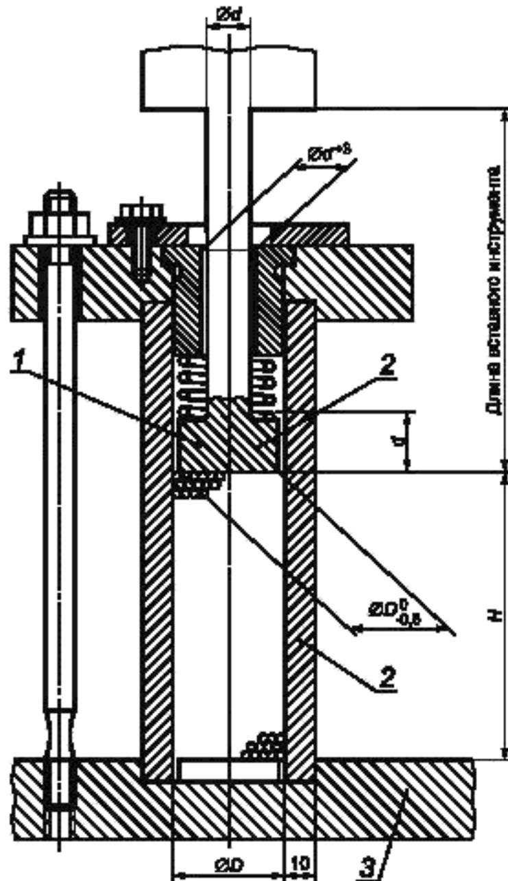
1 — наконечник имитатора вставного инструмента, 2 — закаленная сталь;
