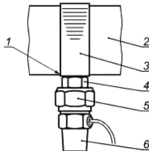
1 – отфрезерованная поверхность; 2 – рукоятка; 3 – хомут; 4 – приварная гайка; 5 – механический фильтр;
