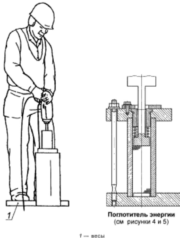
Рисунок 3 — Рабочая поза оператора при испытаниях отбойного молотка
